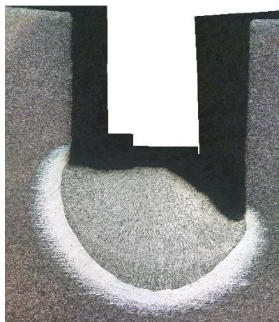
FIGURA 4.21 - Macro do 1º passe do CP 1 ao lado do seu diagrama de dureza.
