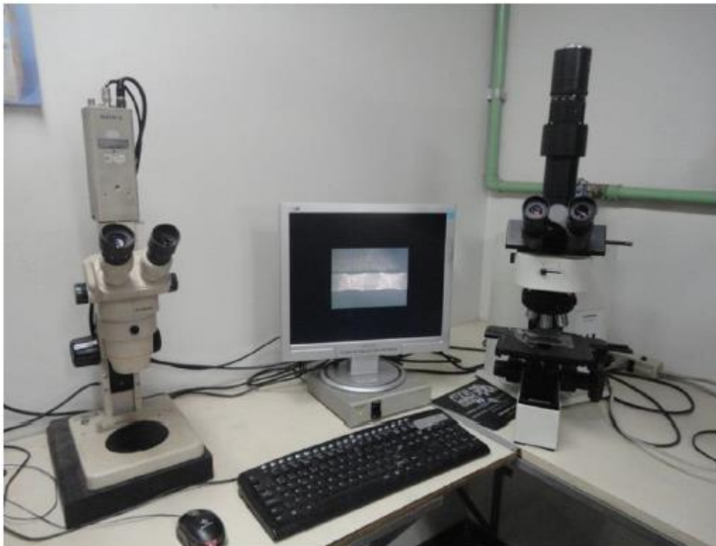
FIGURA 3.20 - Microscópio Olympus SZ-CTV e Olympus BX60M utilizado para realização das micrografias e macrografias.
