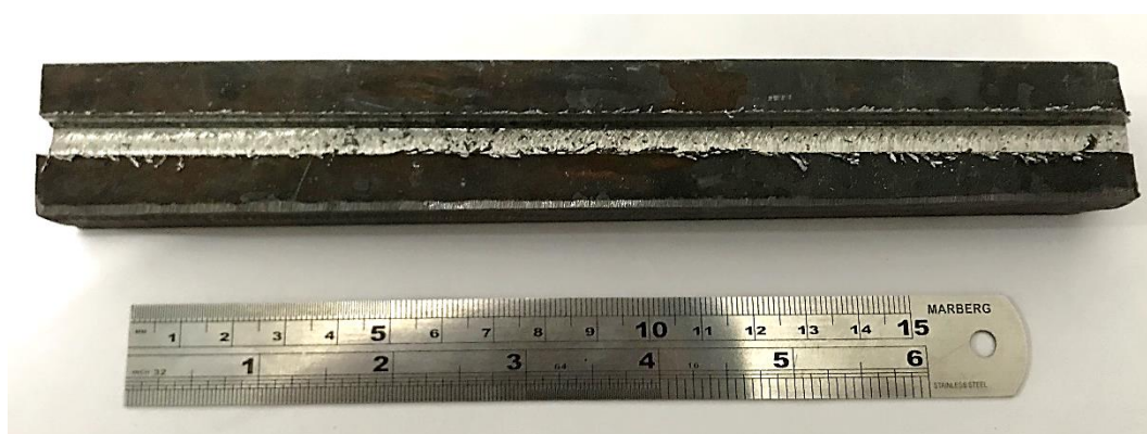
FIGURA 3.2 Chanfro de bordas paralelas utilizado neste trabalho. FONTE – Autor.
