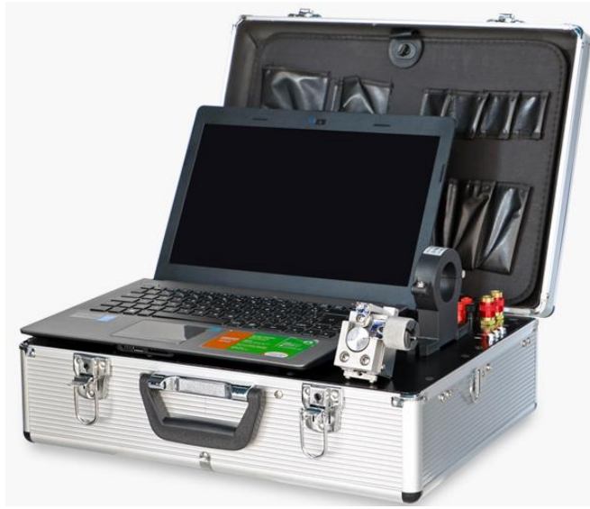
FIGURA 3.7- Sistema SAP V4 utilizado para aquisição da corrente e tensão do processo.
