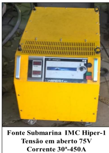
FIGURA 3.5 - Fonte de soldagem IMC Hiper-1 utilizada para soldagem subaquática dos corpos de prova.
