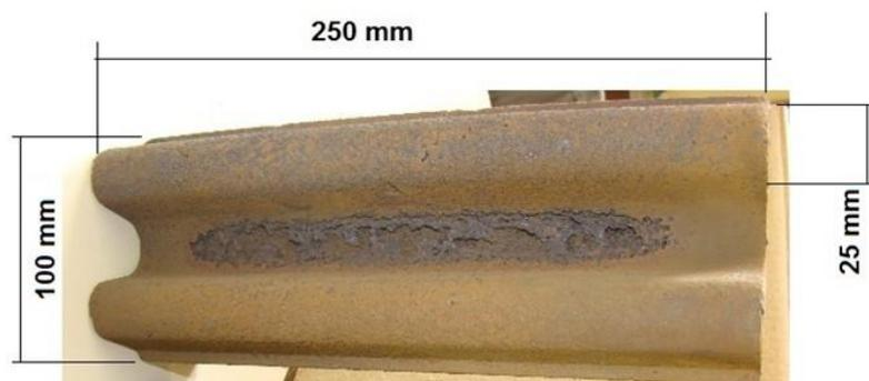
Figura 4.2 - Bloco fundido do tipo Keel obtido.
