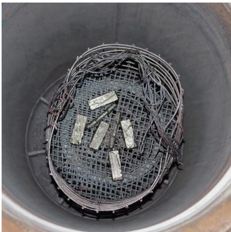
Figura 4.3 - Corpos de provas de tração e de desgaste posicionados no interior do forno de aquecimento para o tratamento térmico.
