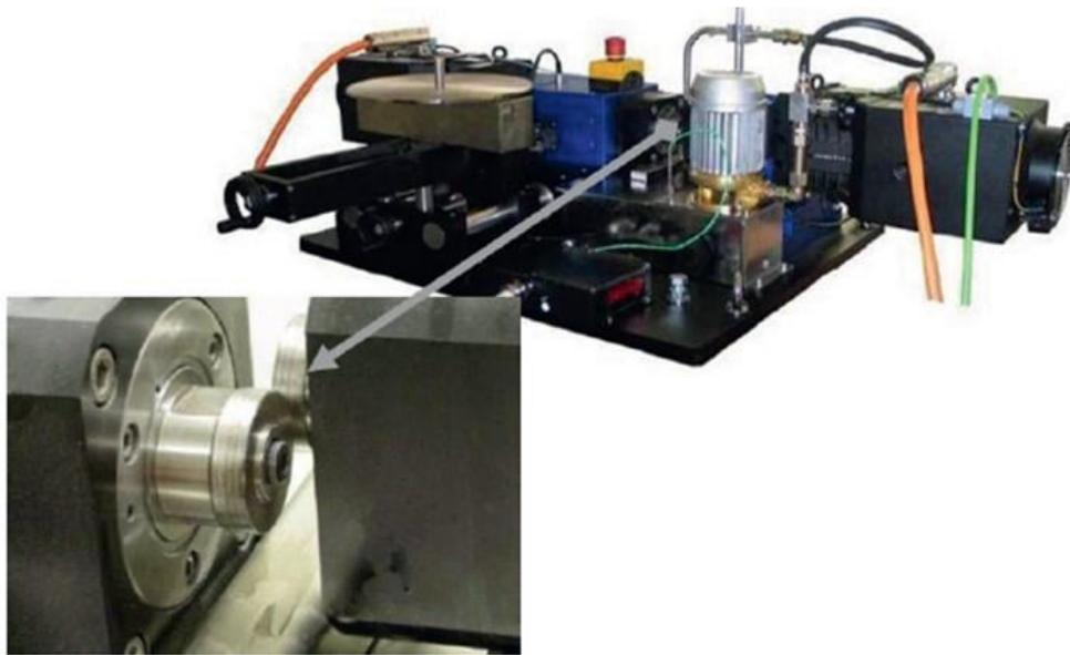
Figura 3.13 - Detalhe dos discos montados do tribômetro disco duplo UTM 2000. Fonte: LEIRO, 2012.
