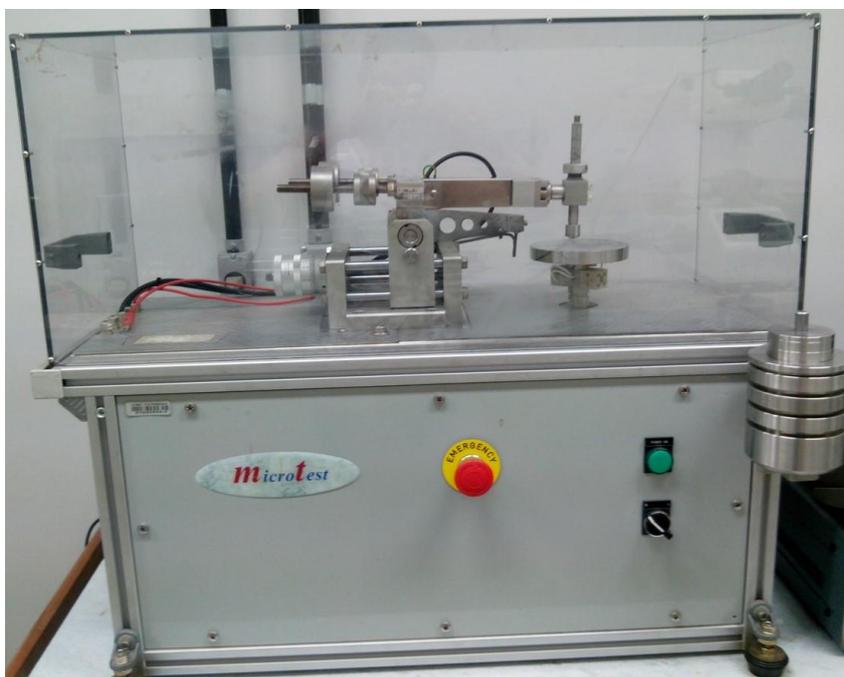
Figura 4.7 - Tribômetro modo esfera/disco do laboratório de Tribologia e desgaste da Universidade Federal de Minas Gerais. Fonte: a autora.
