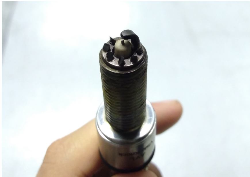
Figura 3 – Vela instrumentada com cabos de fibra óptica para medição de luminosidade dentro do cilindro.
