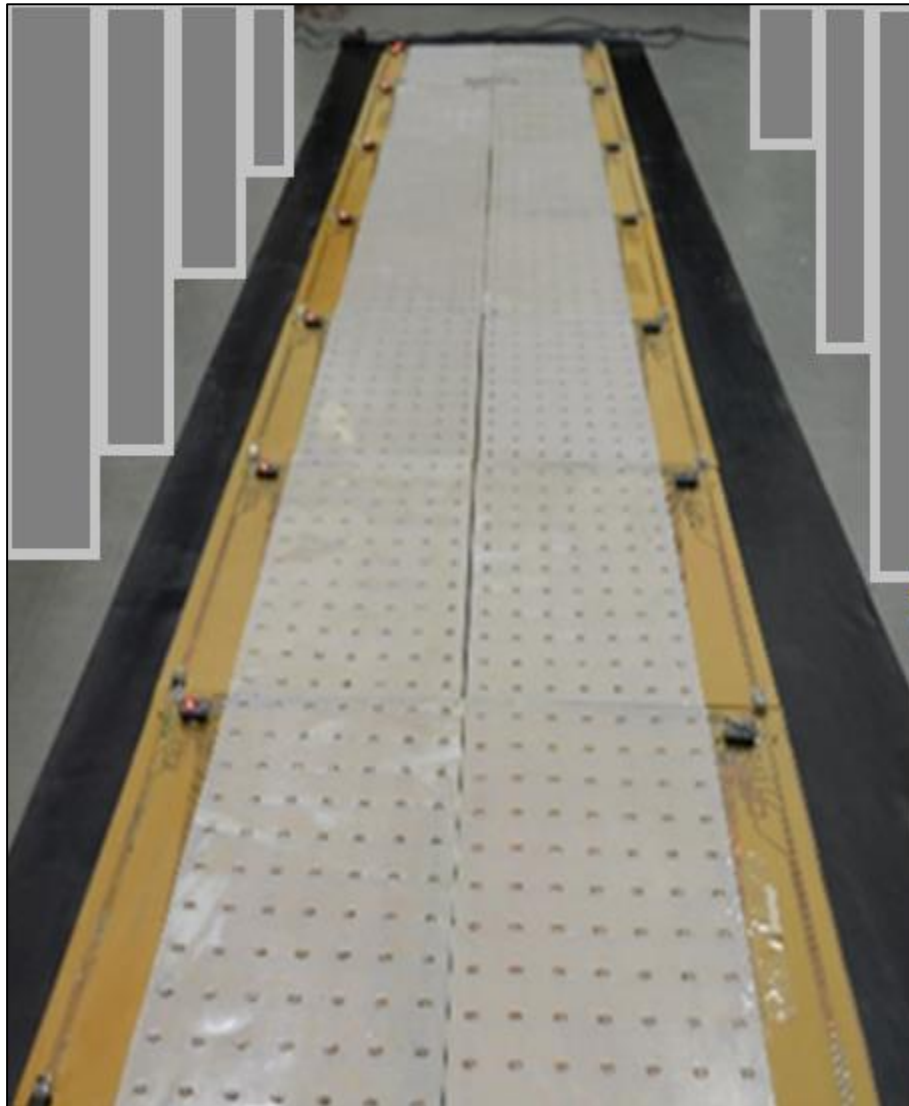
FIG 5.3 - Sistema de medição tátil em fase de construção e testes, contendo a placa vazada para proteção dos sensores.
