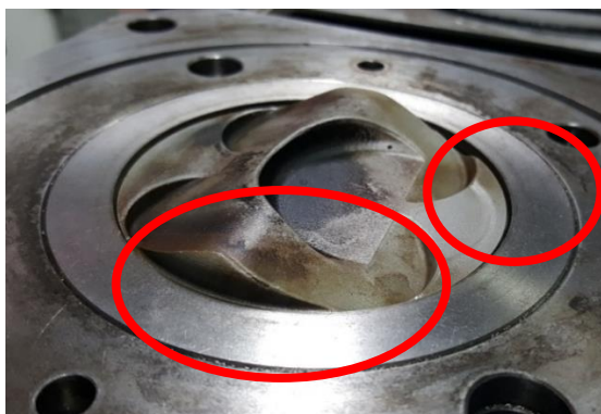
Figura 27 – Pistão no PMS para análise de regiões acima e abaixo do bloco
