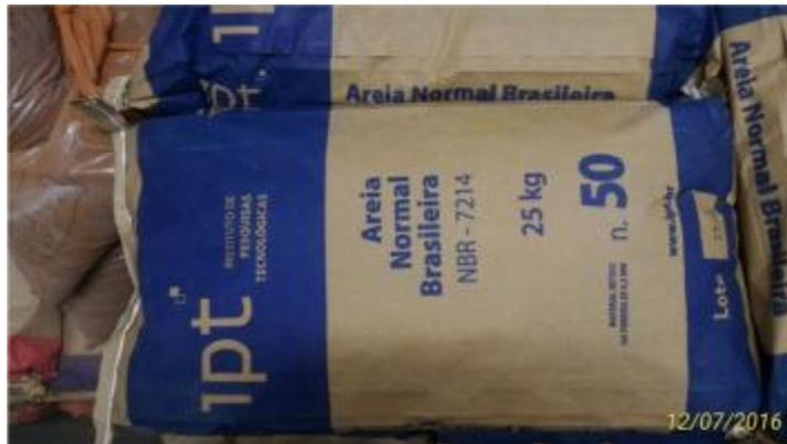
Figura 4.11: Material padrão utilizado do IPT
