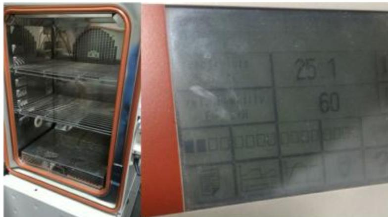
Figura 4.4: Câmara de armazenamento de amostras controlando a temperatura e umidade.
