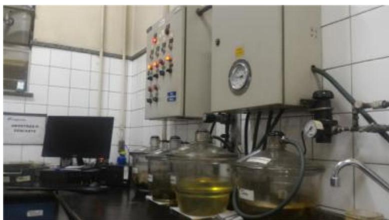
Figura 4.5: Câmaras utilizadas para vácuo, possibilitando a penetração da água nos poros das amostras.
