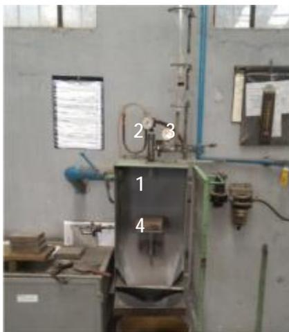
Figura 4.7: Erosímetro. 1: Jato; 2: Regulador de pressão; 3: Tubo de estabilização do jato; 4: Amostra a ser testada
