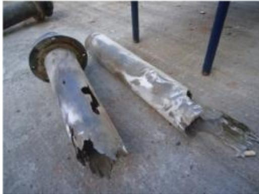
Figura 3.7: Desgaste em um tubo metálico. Transporte pneumático de cinzas, temperatura de 140 °C
