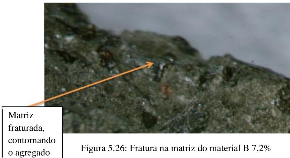
Figura 5.26: Fratura na matriz do material B 7,2%
