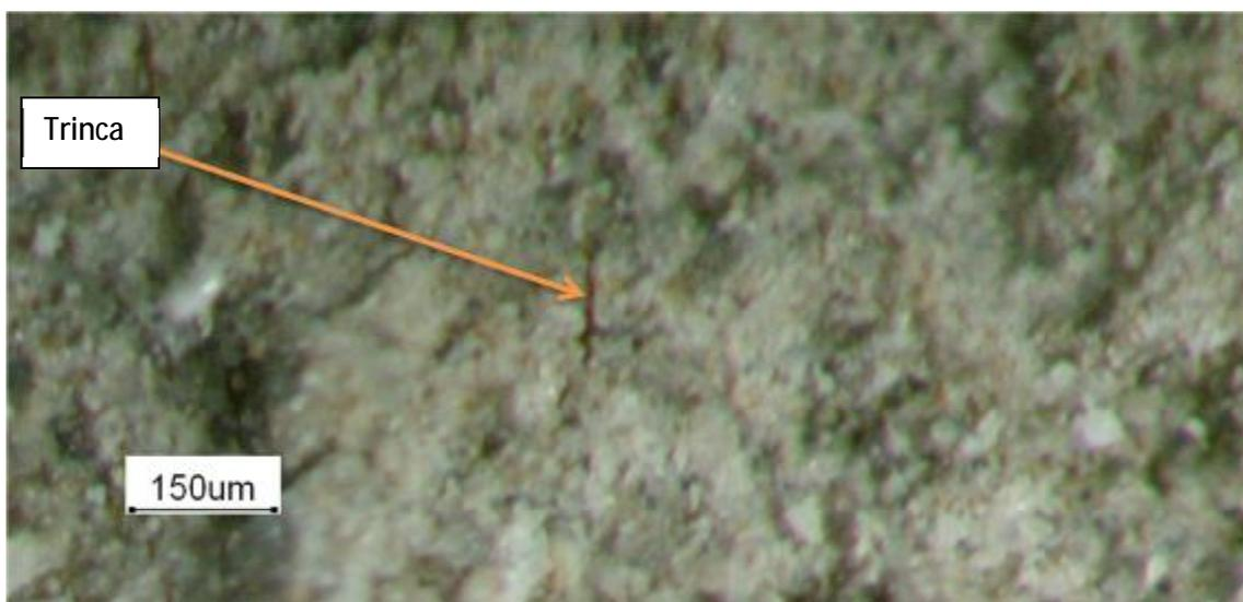
Figura 5.40: Região de desprendimento de agregado a partir da formação de trincas para a peça C 8%
