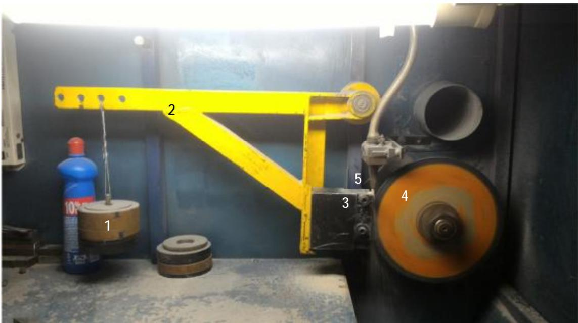
Figura 4.8: Máquina de ensaios G-65 adaptada: 1: Peso; 2: Alavanca; 3: Amostra; 4: Roda de borracha; 5: Bico de vazão do abrasivo
