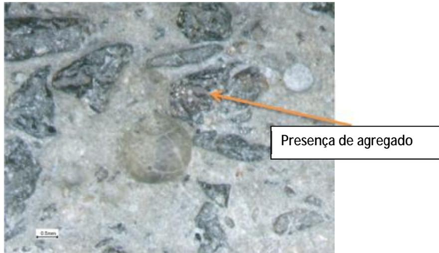
Figura 5.51: Imagem após 10 minutos de desgaste abrasivo do material B 4,8%, ainda com a presença do agregado
