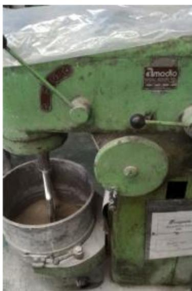
Figura 4.3: Misturador utilizado para garantir a mistura correta do material
