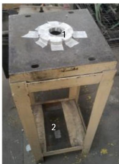
Figura 4.6: Mesa utilizada para teste de tenacidade à fratura. 1: Furo para projeção de bola de impacto; 2: Amostra
