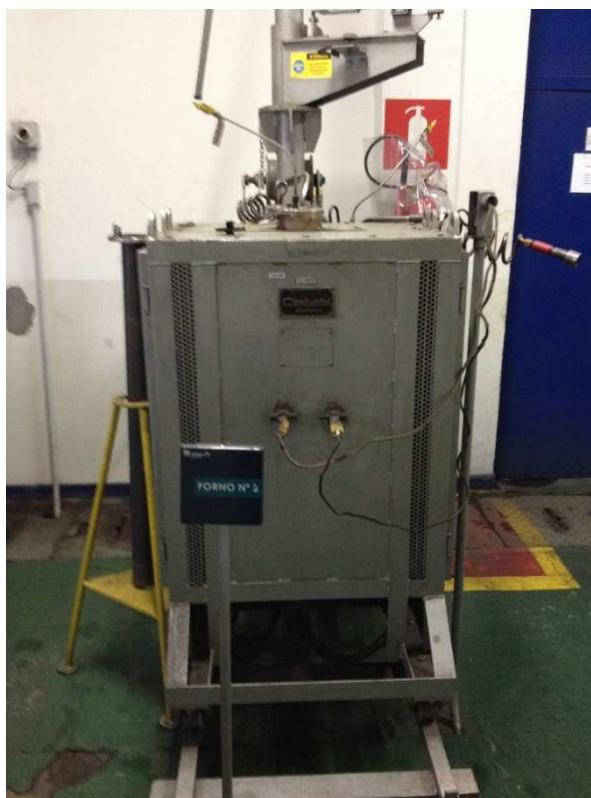
Figura 4.7 – Forno vertical para análise RDI marca Combustol.
