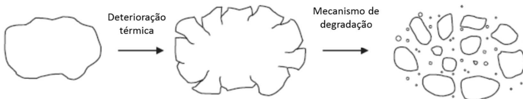
Figura 3.15 – Modelo de degradação da partícula de minério após aquecimento (adaptado Strezov et al., 2013).
