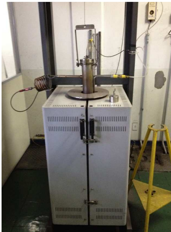
Figura 4.6 – Forno vertical para análise IR marca Analógica.
