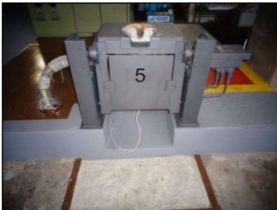
Figura 4.2 – Forno de fusão elétrico à indução de média frequência com cadinho de capacidade de 20 kg de aço líquido.
