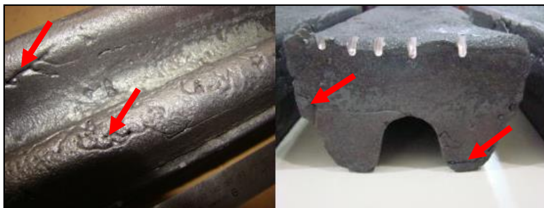
Figura 5.32 – Defeitos superficiais nos blocos Keel .
