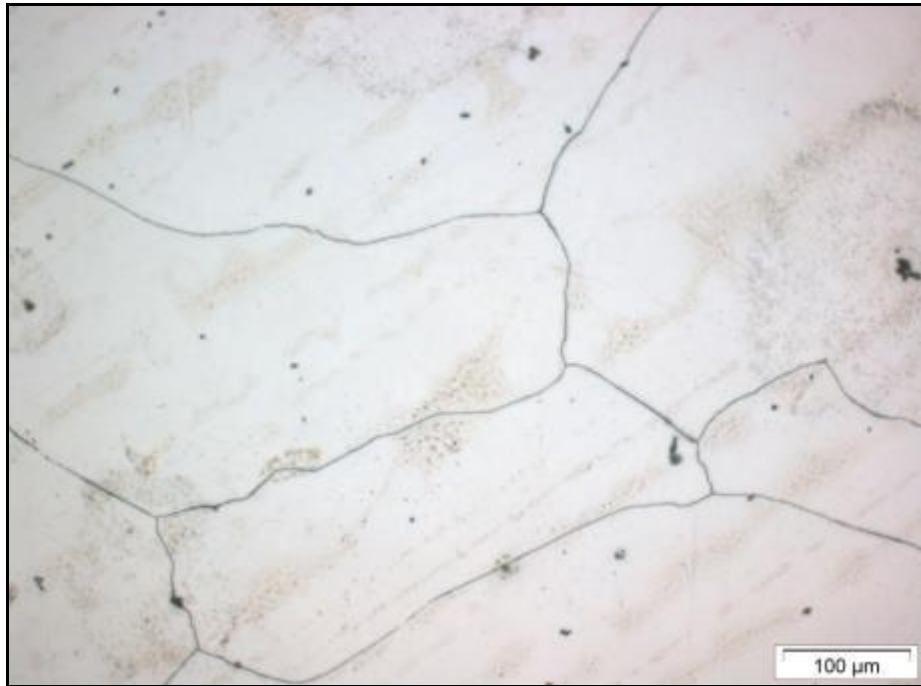
Figura 5.9 – Tamanho de grãos do bloquinho bruto de fundição. Ataque químico: Solução de Ácido Pírico aquoso saturado.
