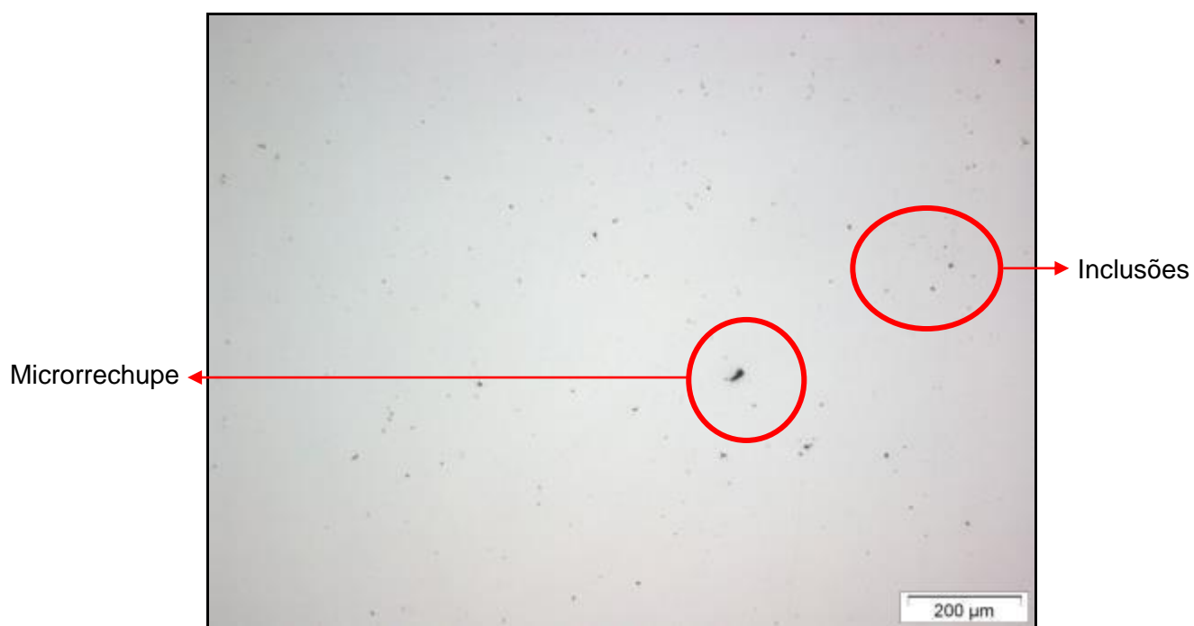
Figura 5.3 – Microestrutura sem ataque químico da amostra retirada da seção útil do corpo de prova “Bloquinho bruto de fundição”.
