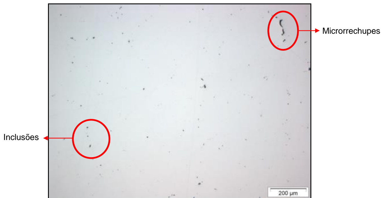
Figura 5.4 – Microestrutura sem ataque químico da amostra retirada da seção útil do corpo de prova “Bloquinho tratado termicamente”.
