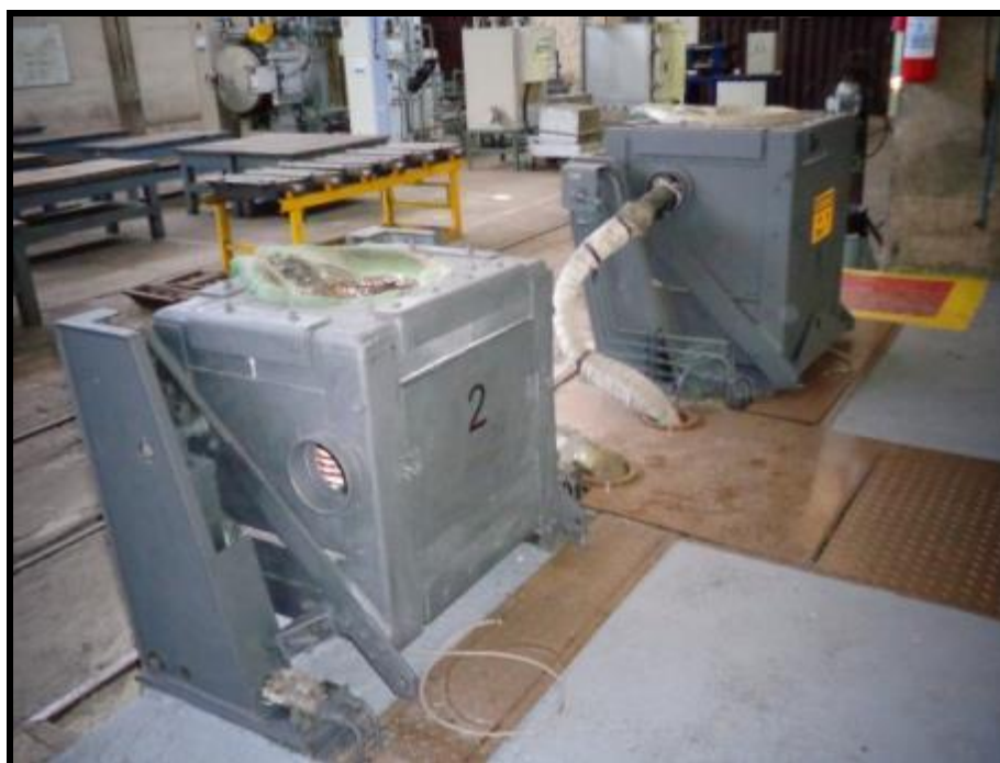
Figura 4.13 – Forno de fusão elétrico à indução de média frequência
