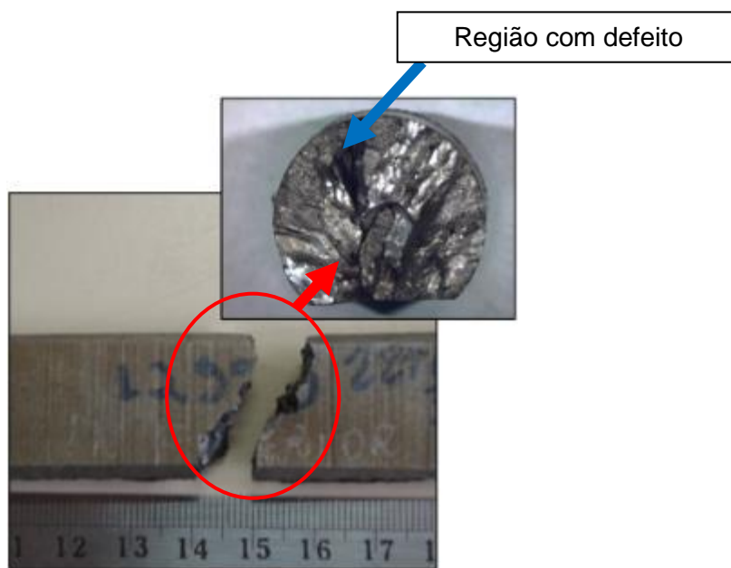
Figura 5.26 – Aspecto da fratura da barra rompida durante a usinagem.
