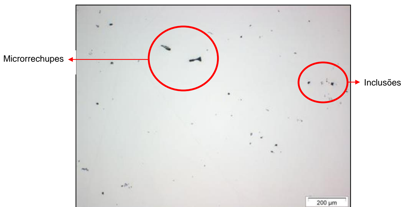
Figura 5.1 – Microestrutura sem ataque químico da amostra retirada da seção útil do corpo de prova “Bloco Keel bruto de fundição”.
