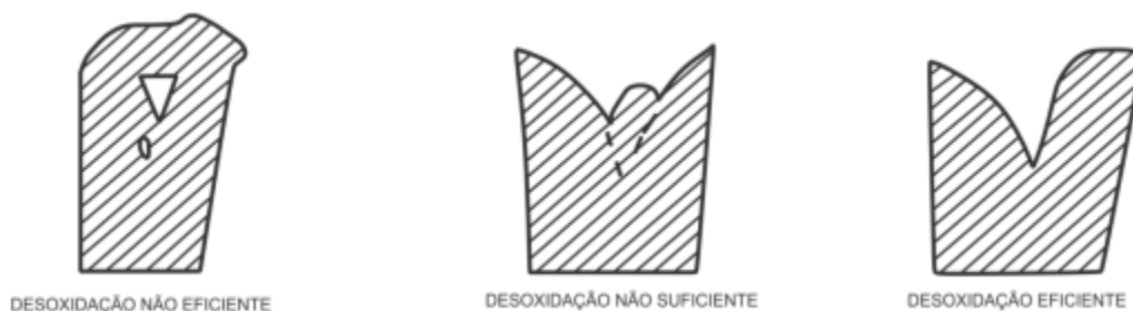
Figura 3.6 – Visualização após corte do corpo de prova para controle de desoxidação. Fonte: Fonseca, 2001.
