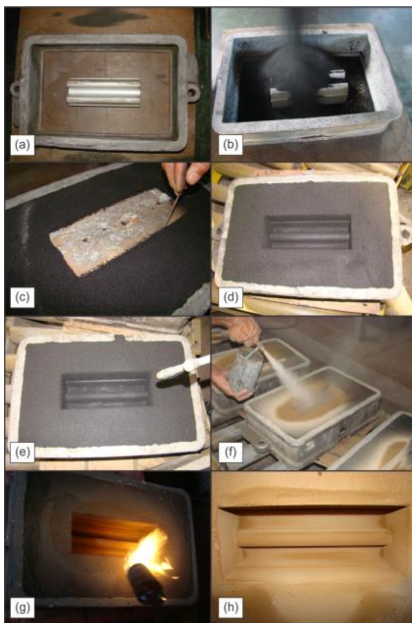
Figura 4.5 – Etapas da moldação para obtenção do bloco Keel .
