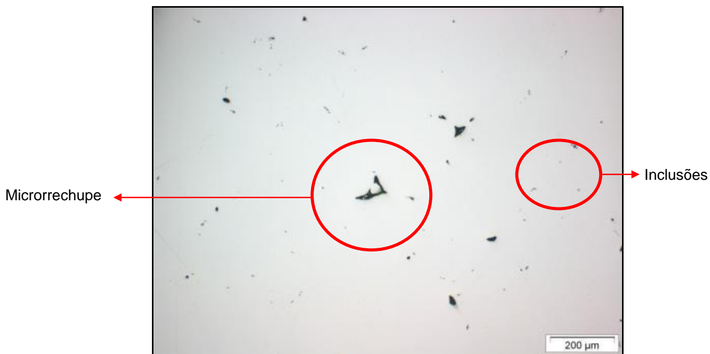
Figura 5.2 – Microestrutura sem ataque químico da amostra retirada da seção útil do corpo de prova “Bloco Keel tratado termicamente”.
