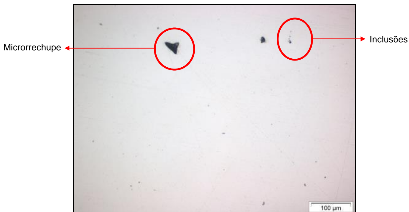
Figura 5.15 – Microestrutura sem ataque químico da amostra retirada da seção útil do corpo de prova Cp3 LE superior.
