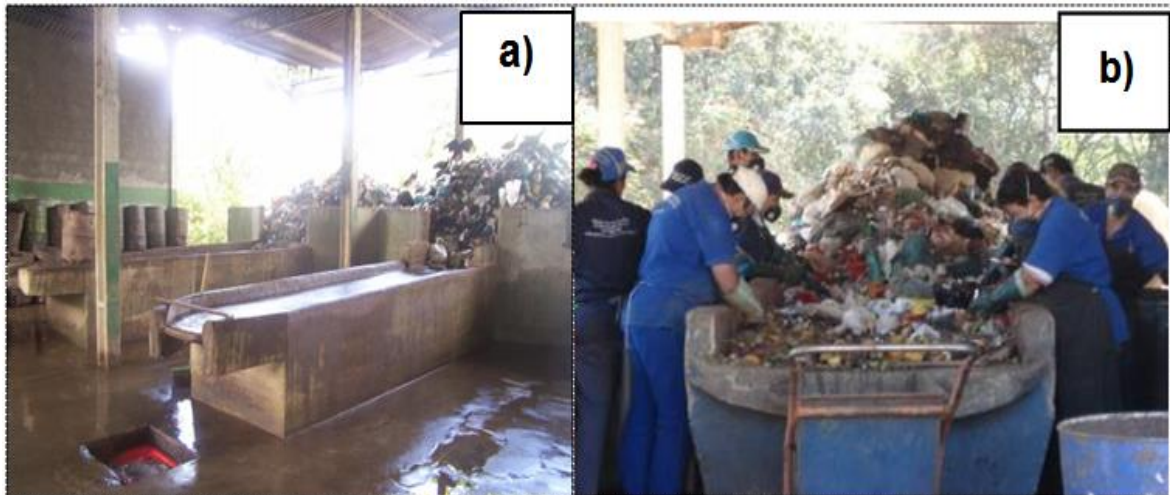
Figura 3.4 – Mesas de concreto para triagem: a) UTC no Rio de Janeiro (IACONO, 2007) e b) UTC em Minas Gerais (ANDRADE, 2010)
