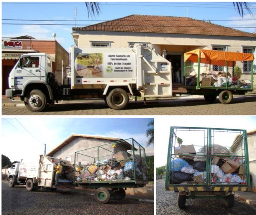
Figura 5.2 - Carroceria adaptada com gaiola acoplada utilizada no Município de Tibagi-PR
