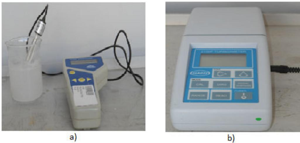
**Figura 4.2** – a) pHmetro digital PG1400;      b) Turbidímetro HACH 2100P.
