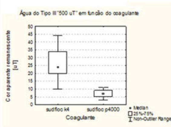
**Figura 5.19f** – *Boxplot* dos resultados de cor aparente remanescente em água do Tipo I "500 uT" prédecantada em função do coagulante aplicado na coagulação seguida de filtração direta (PS-FD).
