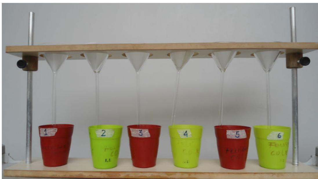
**Figura 4.4** – Suportes de funis contendo filtros de papel usados para simulação da filtração direta após pressedimentação.
