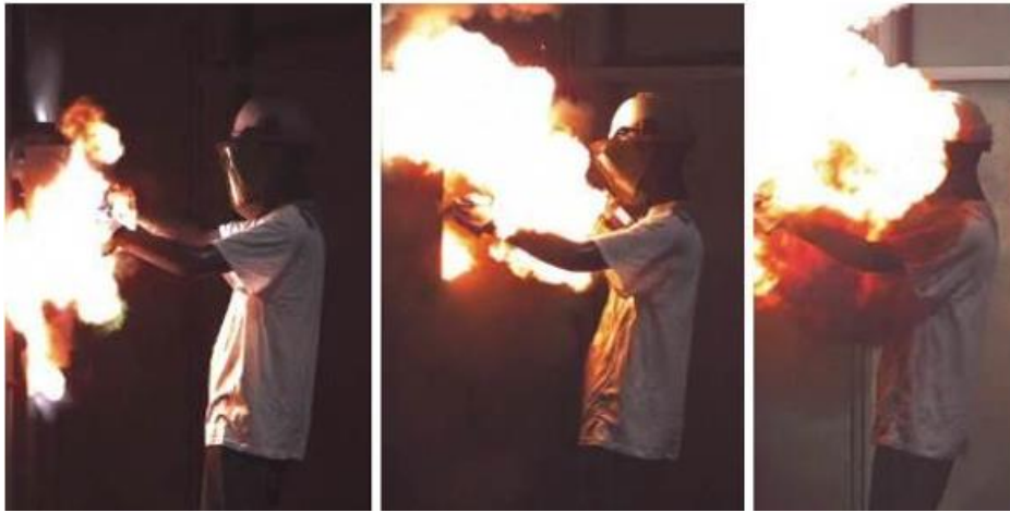
Figura 4.9 – Evento com ocorrência de arco elétrico – Fonte [34]
