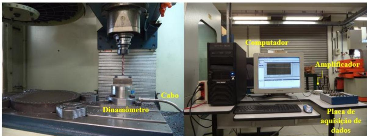
FIGURA 3.10: Sistema de aquisição de dados
