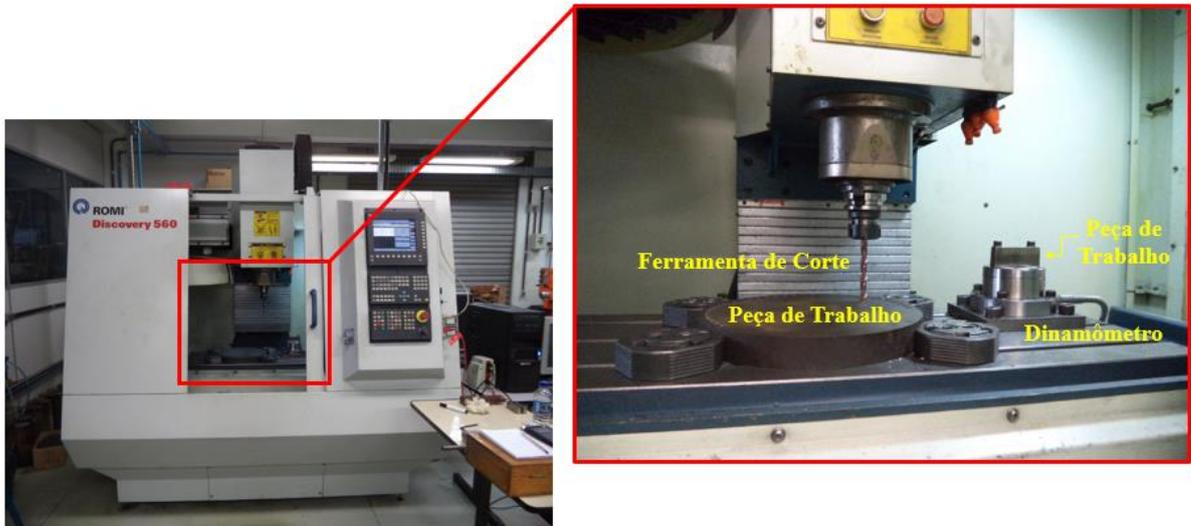
FIGURA 3.9: Centro de usinagem – montagem do experimento
