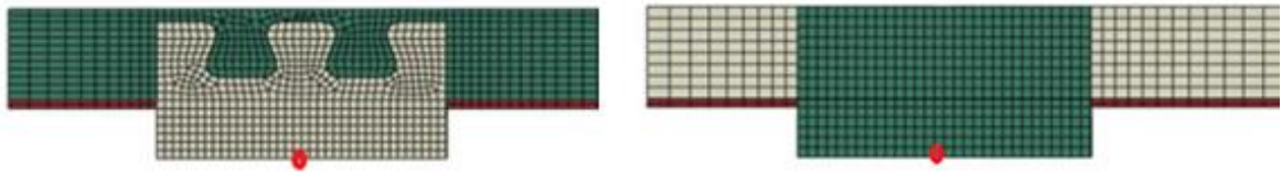
Figura 4.3 - Pontos de Medição de Temperatura no Crestbond e na Chapa Passante em Pilares de Diâmetro de 200mm
