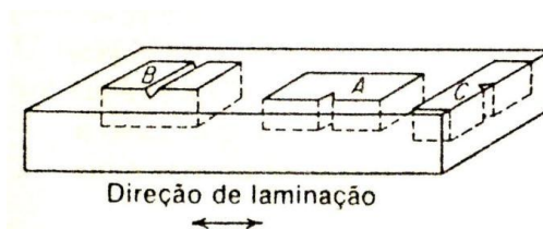
Figura 4.5 – Desenho esquemático da orientação de corpos de prova s para ensaios de impacto Charpy .
