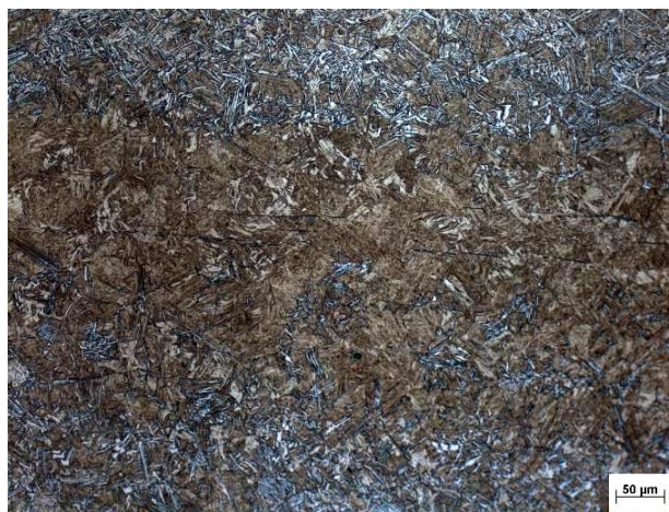
Figura 5.13 - Aspecto da microestrutura na região do centro da espessura da amostra tratada por têmpera direta evidenciando a presença de segregação central Aumento original: 200x. Ataque nital 4%.
