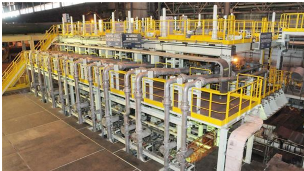
Figura 3.6 – Sistema de resfriamento acelerado acoplado à linha de laminação a quente da Usiminas - Ipatinga
