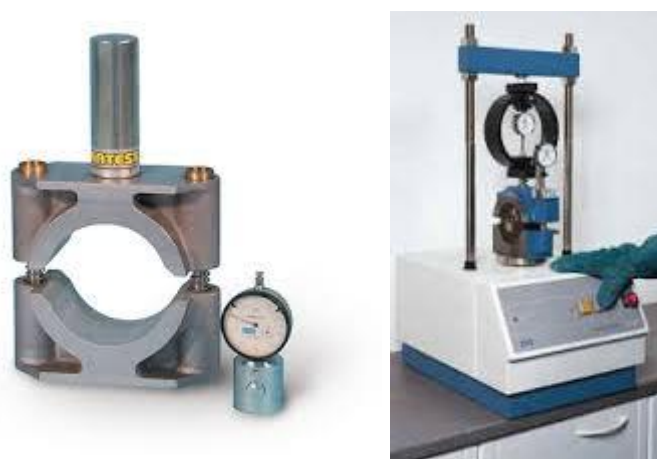
Figura 18: Exemplo de equipamento para o ensaio de estabilidade de Marshall.
