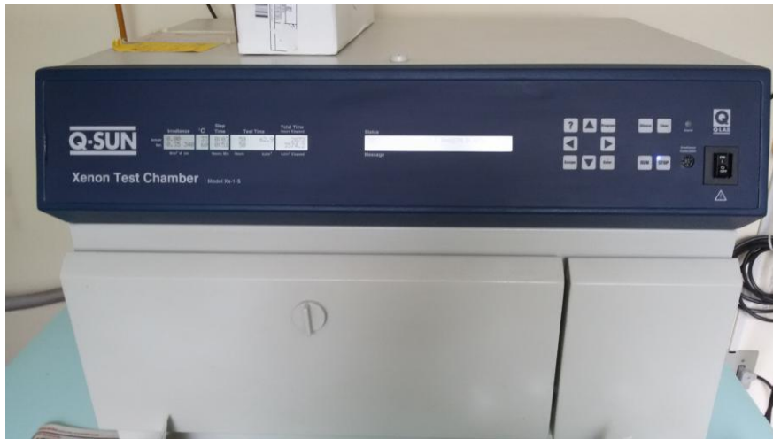
Figura 12: Ilustração da câmara utilizada para realizar testes de intemperismo.
