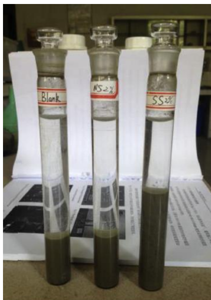
Figura 16 - Comparação entre o volume de sedimentação para soluções de cimento sem nanosílica (Blank), com 2% de nanosílica com aglomerações (NS 2%) e com 2% de nanosílica monodispersa (SS 2%).
