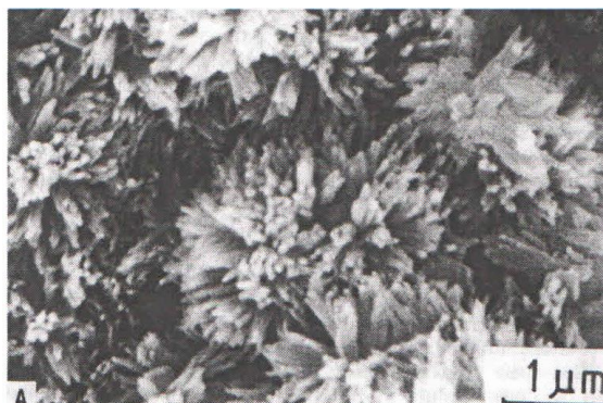
Figura 3 – Imagem MEV de superfície fraturada mostrando C-S-H Tipo I Fonte: TAYLOR, 1997 (cortesia de K.L. Scrivener).
