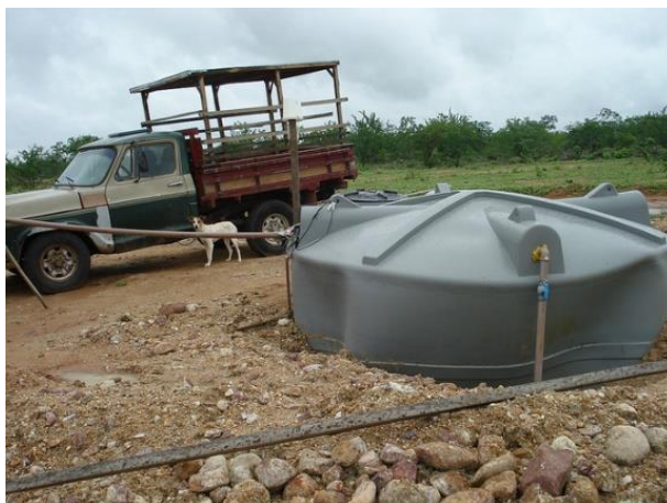
Figura 5.15 - Cisterna de polietileno deformada pelo calor
