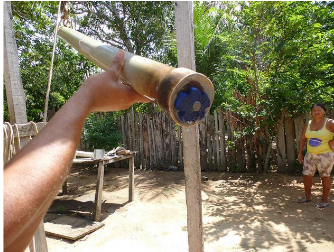
Figura 5.6 - Equipamento utilizado na captação de água proveniente de poços
