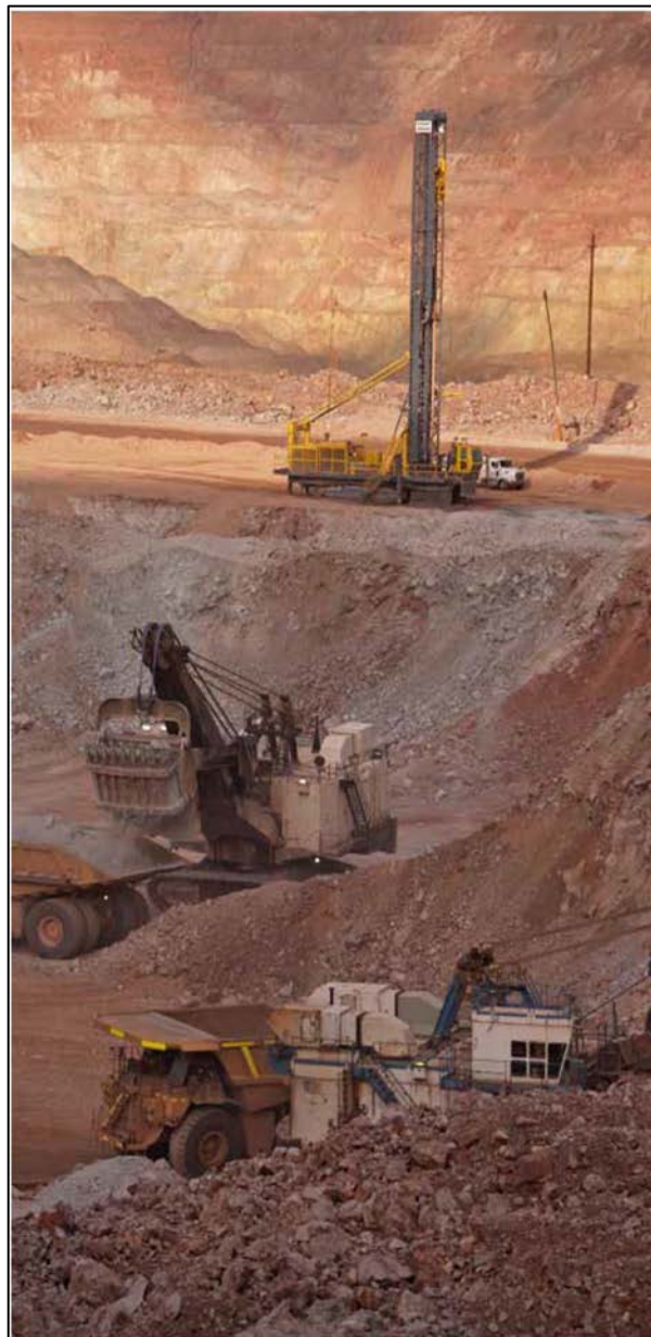
Figura 60 – Operação de perfuração, carregamento e transporte em uma mina no Sudoeste Estados Unidos.
