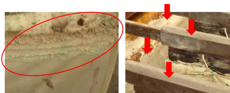
Figura 1.1: Aspecto visual do precipitado de Ca nos diafragmas utilizados nos tanques de eletrorrecuperação de Ni.
