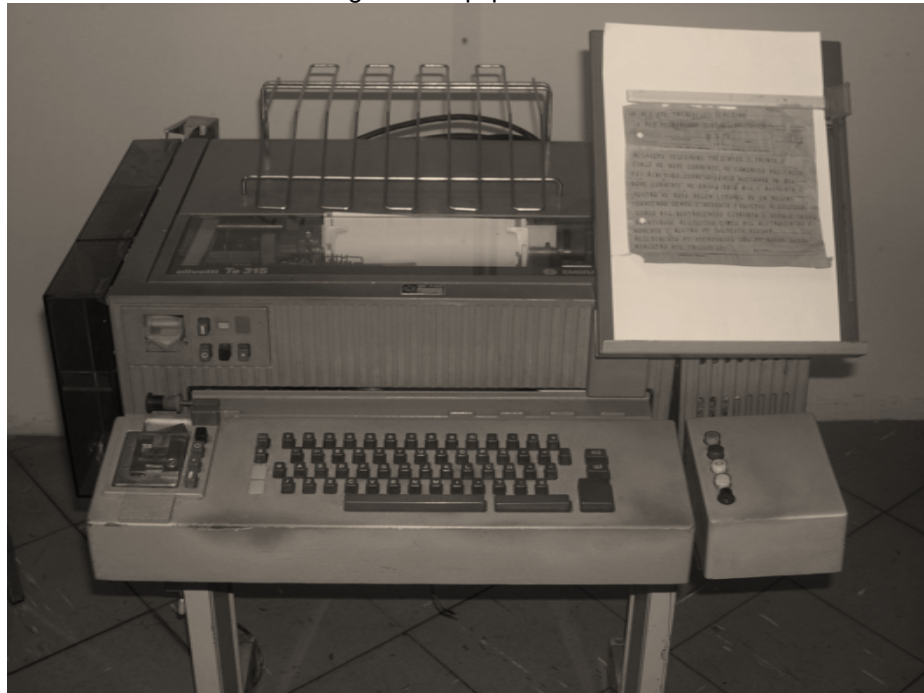
Figura 1: Equipamento de telex.
