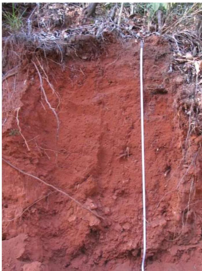
**FIGURA 13: Perfil 3 do Latossolo com elevado teor de argila**
