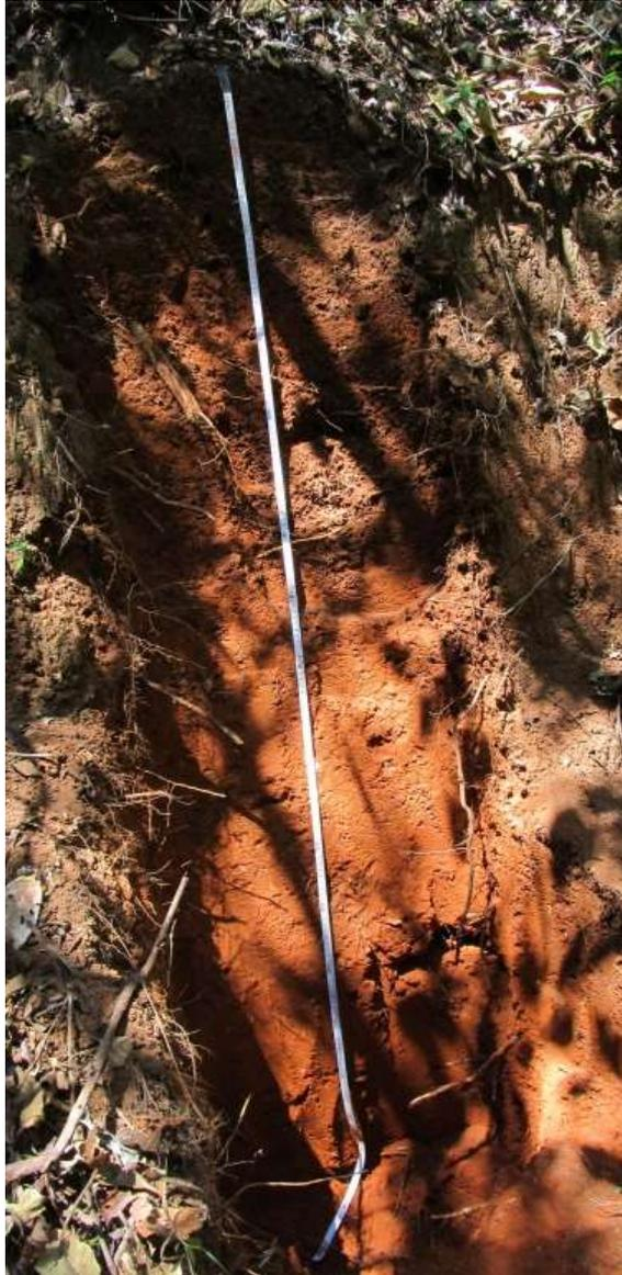
**FIGURA 24: Foto do Latossolo Vermelho (Perfil 8), solo TVO com teores mais significativos de óxidos de Fe**
