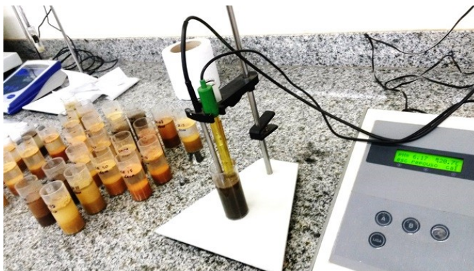
Figura 71: Leitura de amostras em pHmetro calibrado.
