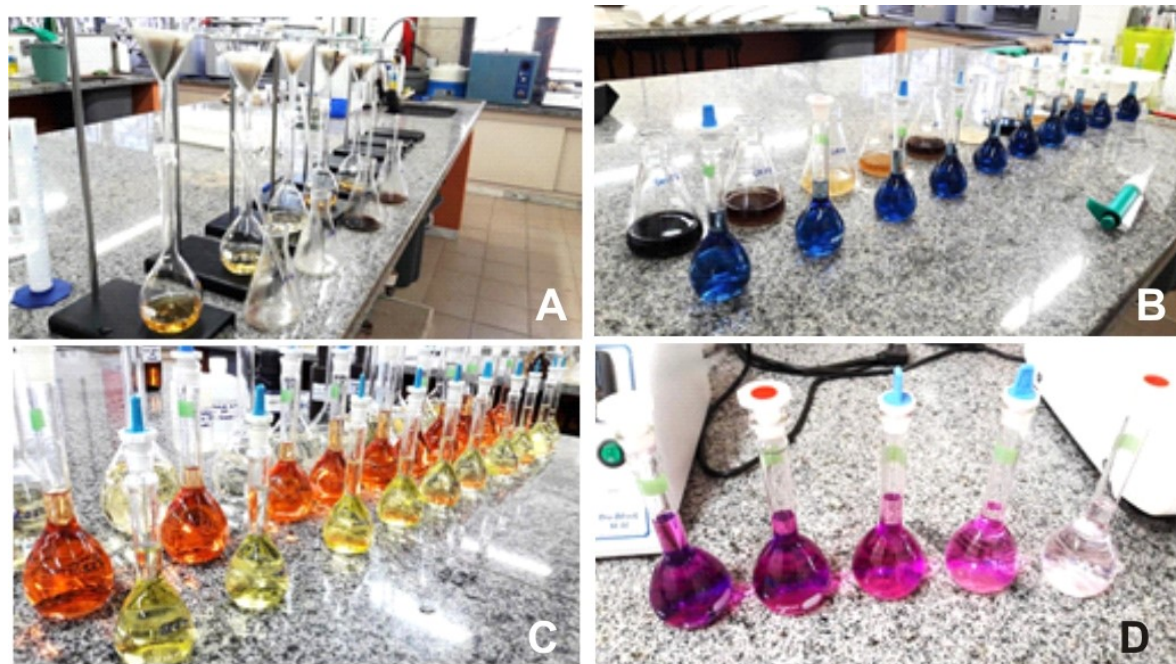
Figura 73: Etapas de extração do extrato e leitura dos elementos.
