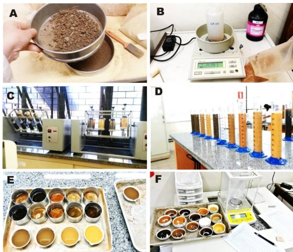
Figura 69: Procedimentos de análise granulométrica por meio da metodologia da pipeta.
