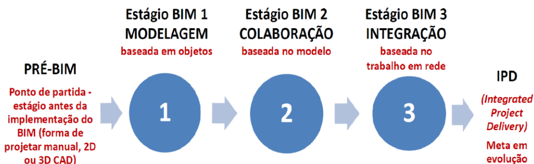
Figura 2.8 - Visão linear da maturidade BIM. Fonte: Adaptação de Succar (2009).
