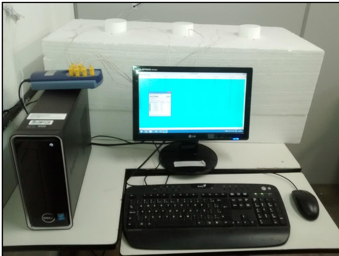
Figura 3.10 – Sistema de medição de temperatura e câmara semi-adiabática.
