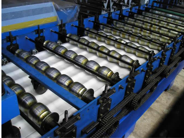
Figura 19 - Processo de perfilação das telhas de aço onduladas
