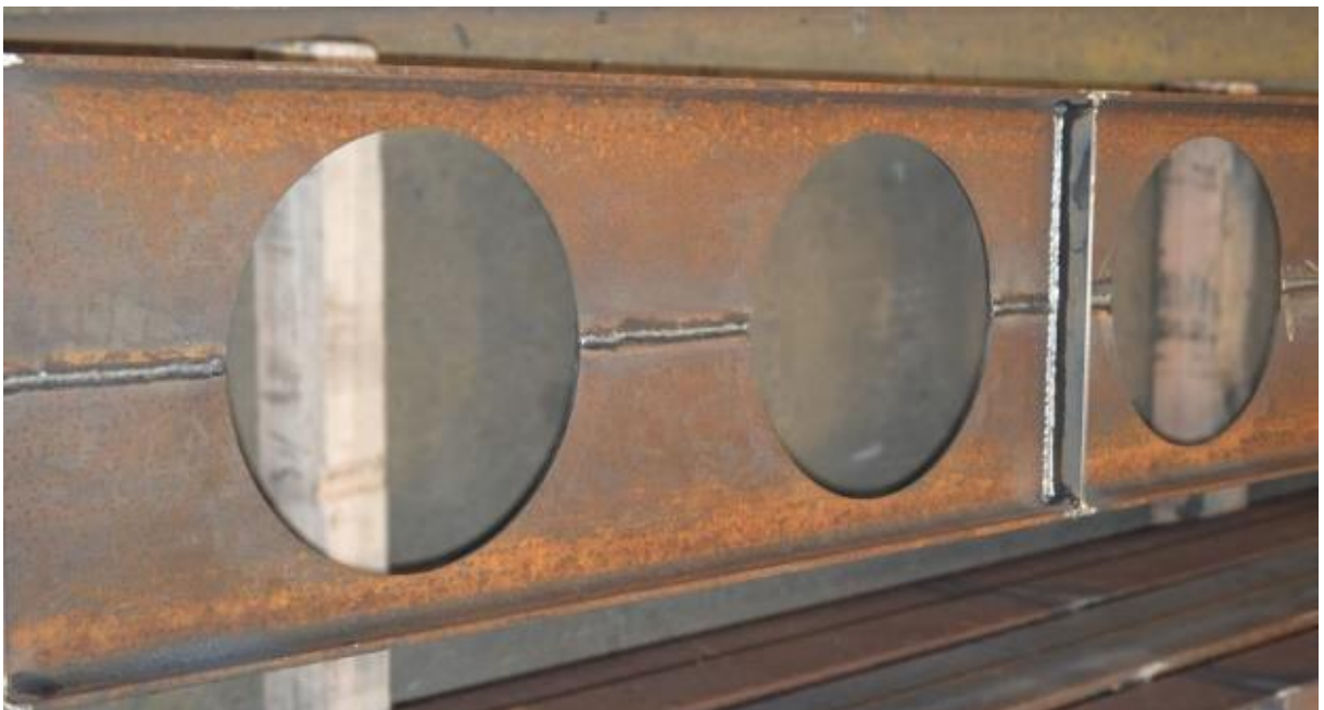
Figura 2.8 – Solda na alma dos montantes de alma
