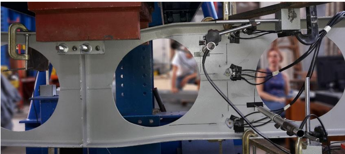
Figura 3.41 – Viga A4 – Falha por mecanismo Vierendeel
