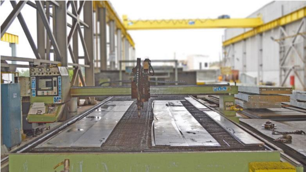
Figura 3.2 – Máquina de corte CNC
