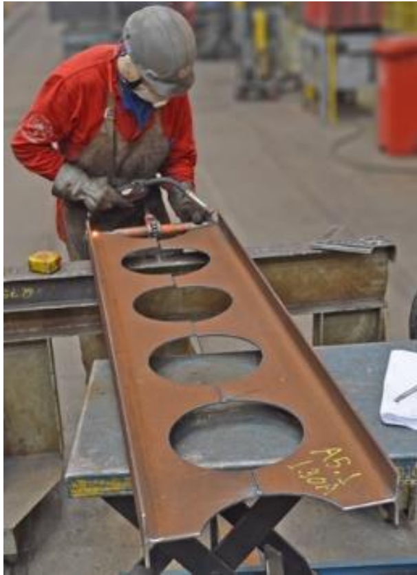
(b) Ponteamento da segunda extremidade
