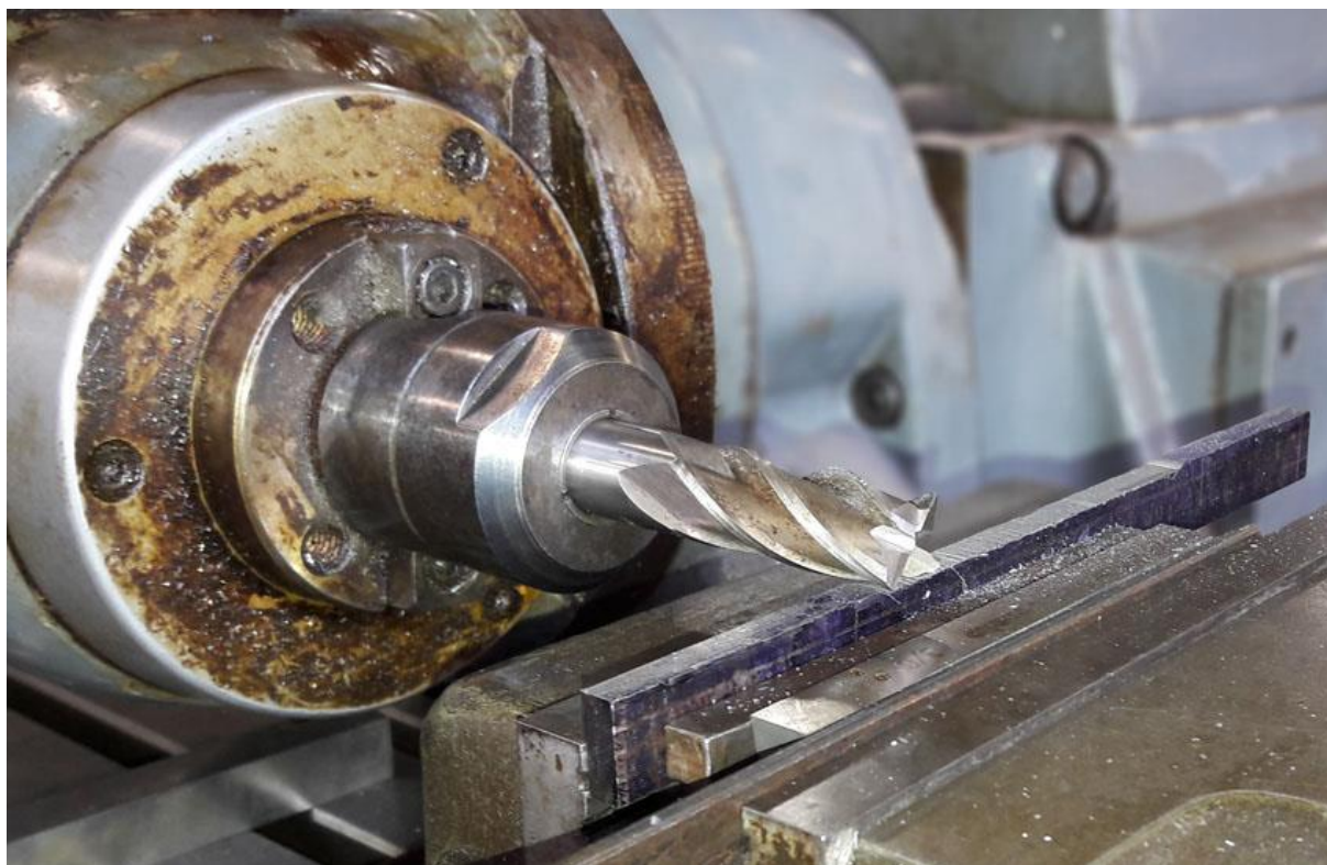
Figura 3.14 – Fresamento dos corpos de prova
