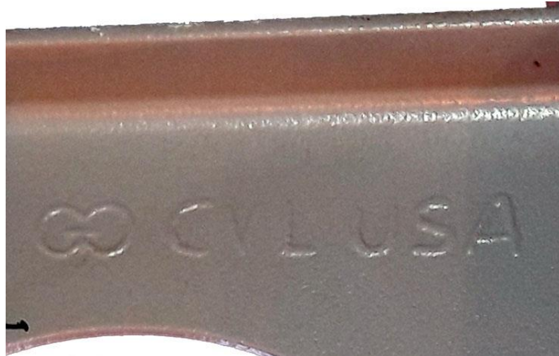
Figura 3.12 – Estampa de identificação da Gerdau USA
