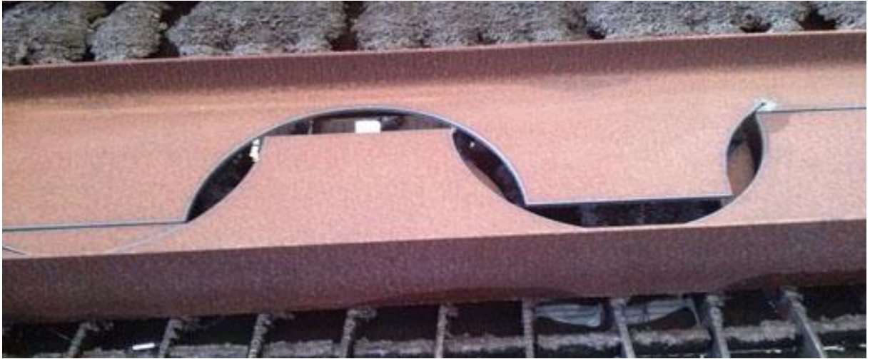
Figura 2.7 – Fabricação de vigas celulares – Material descartado
