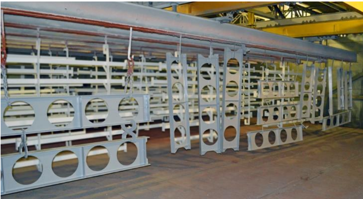
Figura 3.11 – Modelos na estufa de secagem
