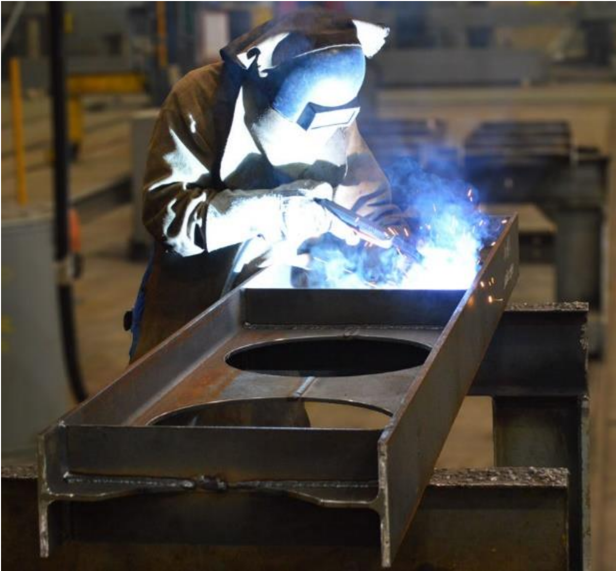
Figura 3.8 – Soldagem manual com solda FCAW
