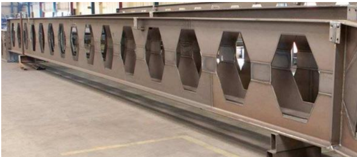
Figura 1.4 – Vigas casteladas com chapas expansoras (fonte: www.hollandprofielplus.nl , 2014)
