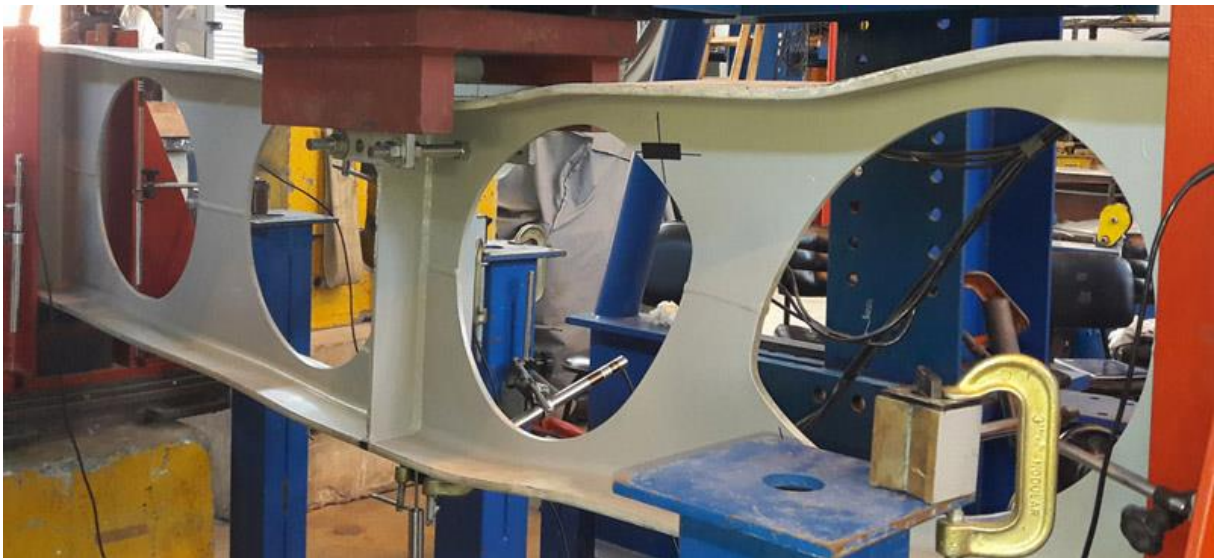
Figura 3.69 – Viga C2 – Deformação na força última
