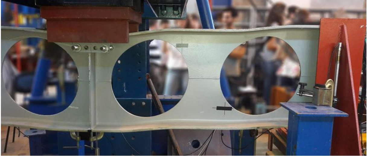
Figura 3.68 – Viga C2 – Deformação anterior à FMAV
