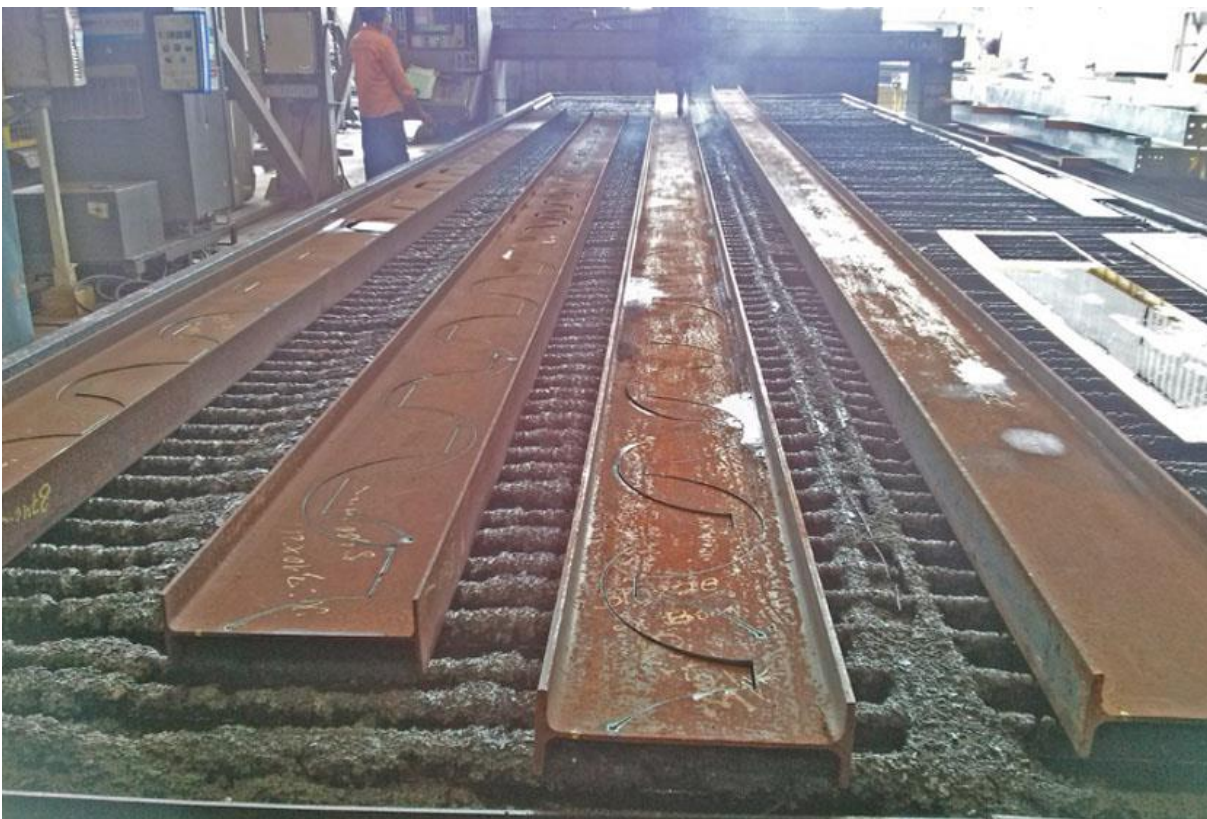
Figura 3.3 – Corte longitudinal nos perfis
