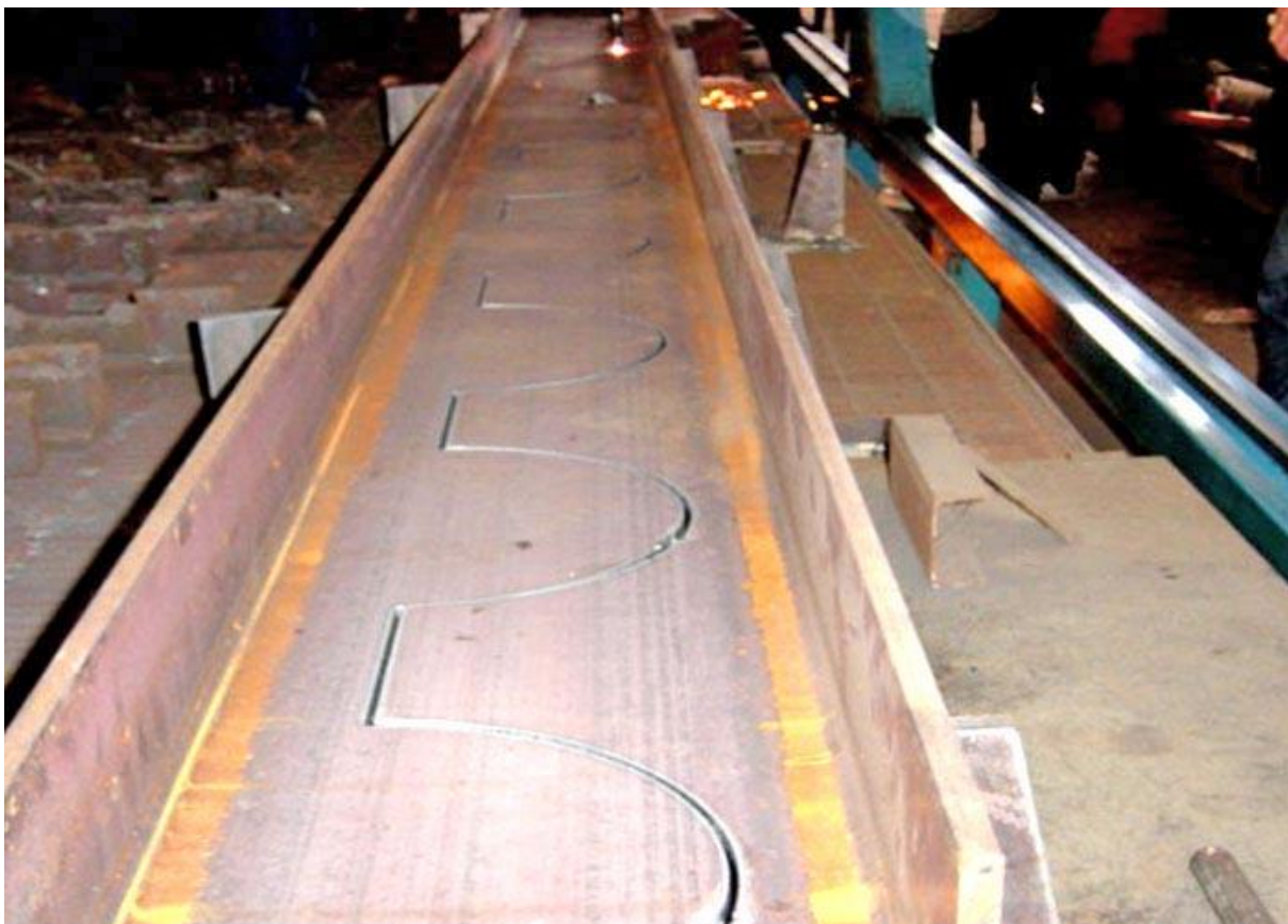
Figura 2.5 – Primeiro corte completo (fonte: www.kloecknermetalsuk.com , 2016)
