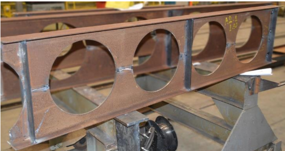
Figura 3.6 – Viga ponteada finalizada
