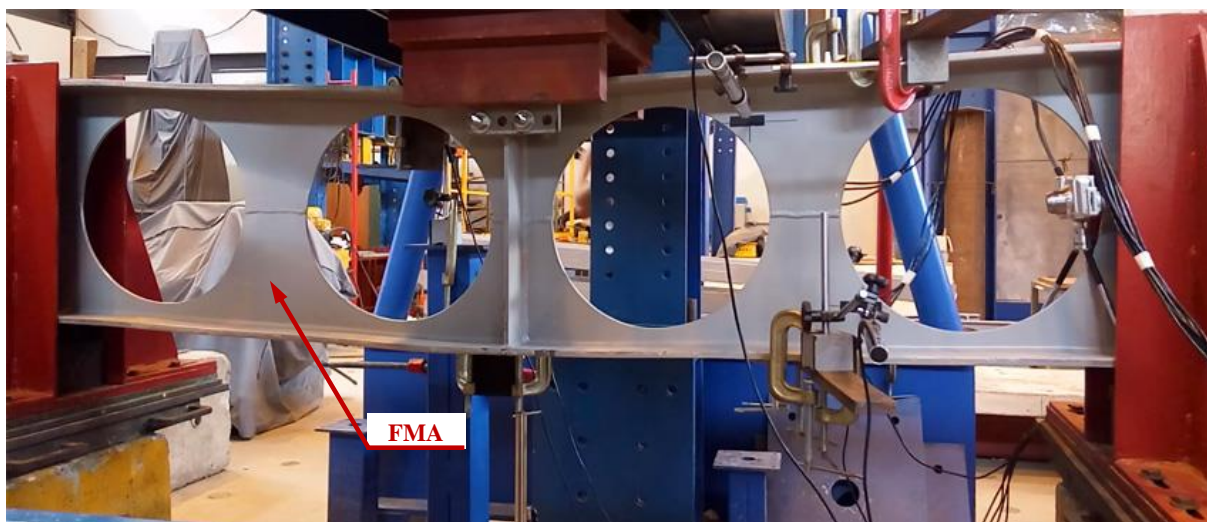
Figura 3.63 – Viga C1 – FMAV no montante da metade não instrumentada da viga
