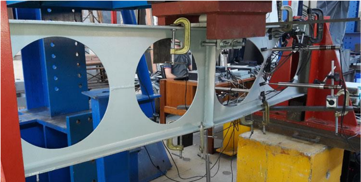
Figura 3.38 – Viga B2 – FMAV no montante instrumentado
