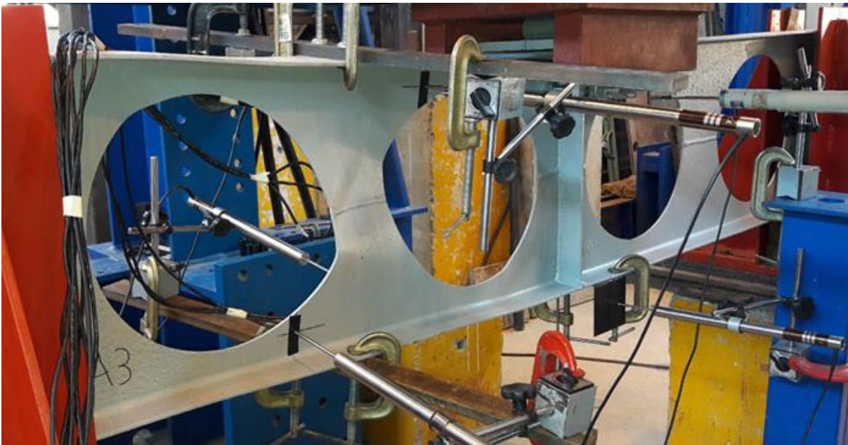
Figura 3.37 – Viga A3 – FMAV no montante instrumentado
