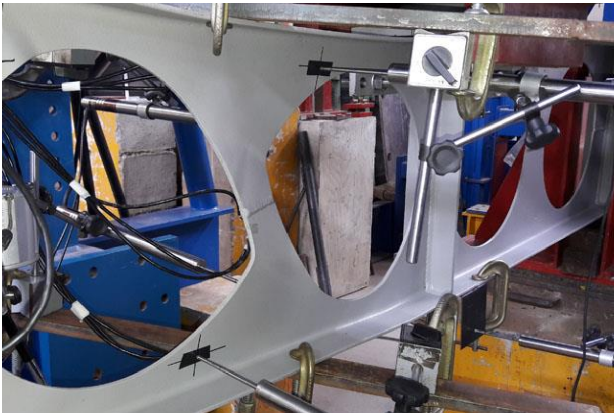
Figura 3.33 – Viga A2 – FMAV em um dos montantes
