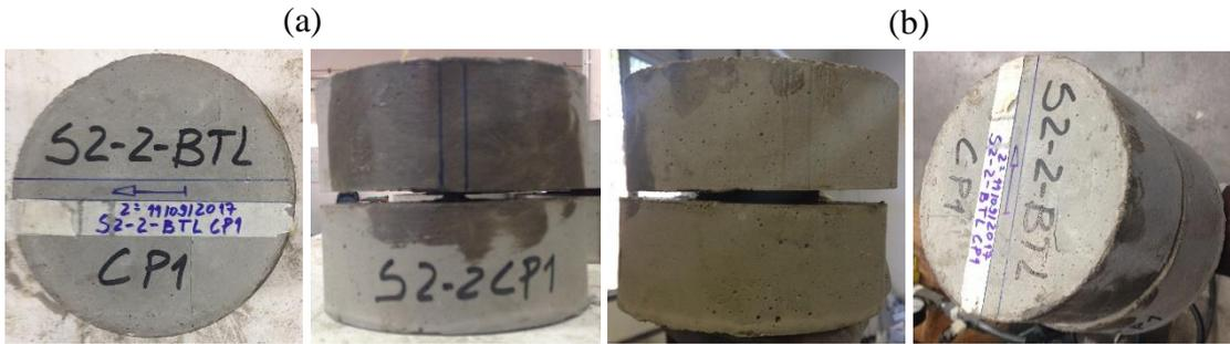
Figura 4.25 – Série S2-2-B-T-L CP1: a) antes e b) depois do ensaio.
