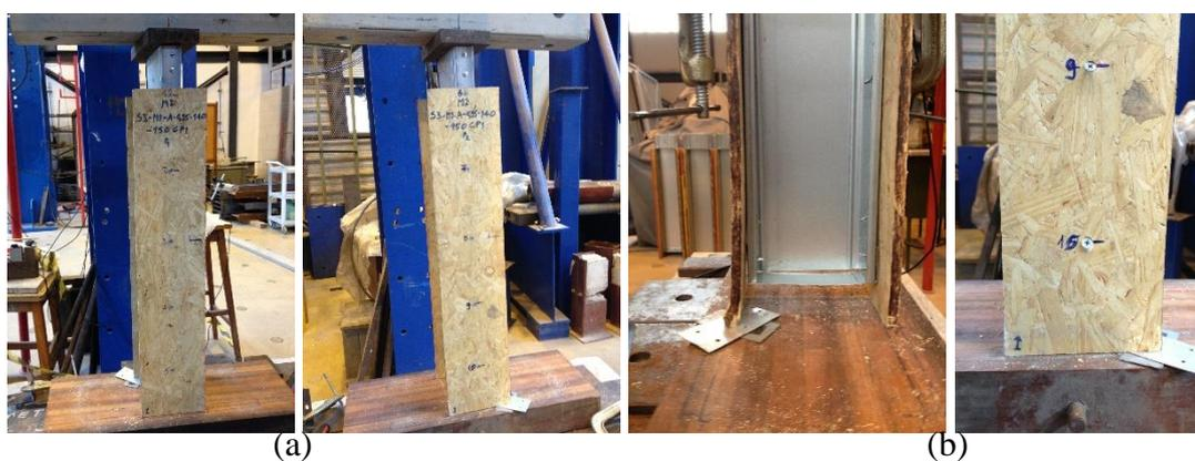
Figura 5.35 – Modelo M2 S3-M1-A-0,95-140-150 CP1: a) antes e b) depois do ensaio.
