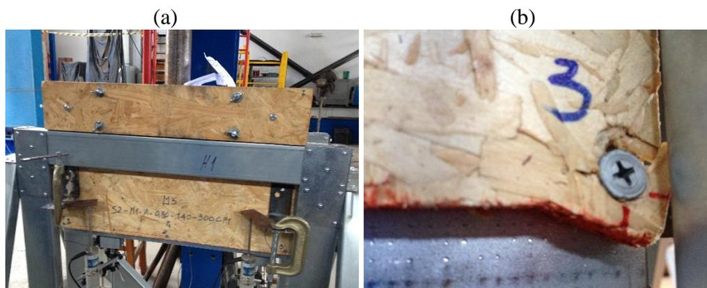
Figura 5.51 – Modelo M3 S2-M1-A-0,80-140-300 CP1: a) antes e b) depois do ensaio.
