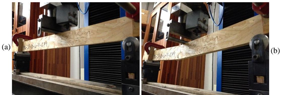
Figura 3.23 – Modelo M2 S7-B-L-V CP1: a) antes e b) depois do ensaio.
