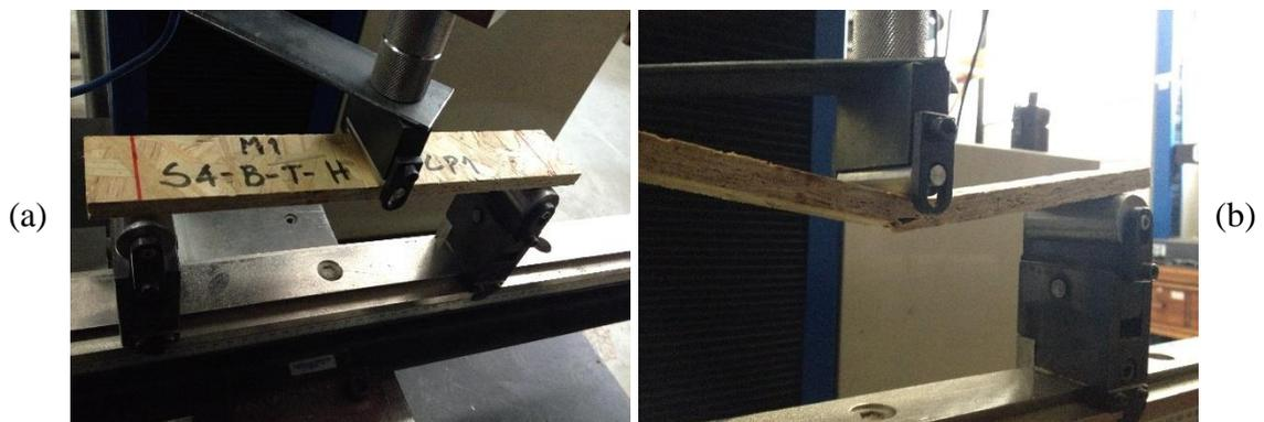
Figura 3.15 – Modelo M1 S4-B-T-H CP1: a) antes e b) depois do ensaio.
