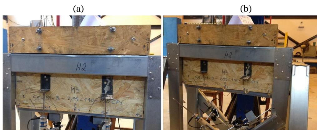
Figura 5.61 – Modelo M3 S9-M1-B-0,95-140-150 CP1: a) antes e b) depois do ensaio.
