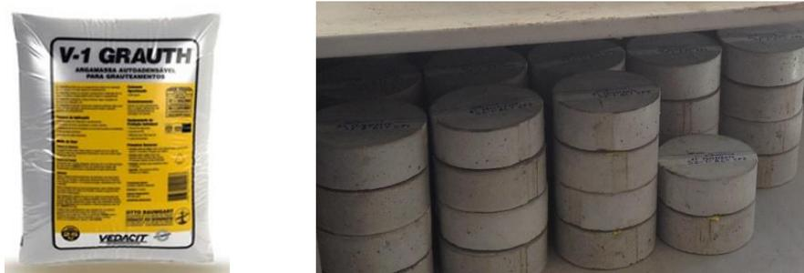
Figura 4.2 – V-1 Grauth e sua aplicação para os ensaios de cisalhamento direto de OSB.
