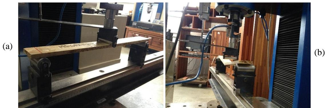
Figura 3.9 – Modelo M1 S1-A-L-H CP1: a) antes e b) depois do ensaio.
