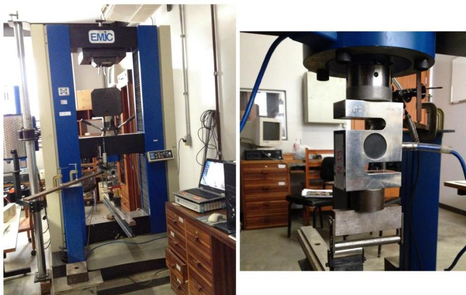
Figura 3.4 – Máquina de carregamento.
