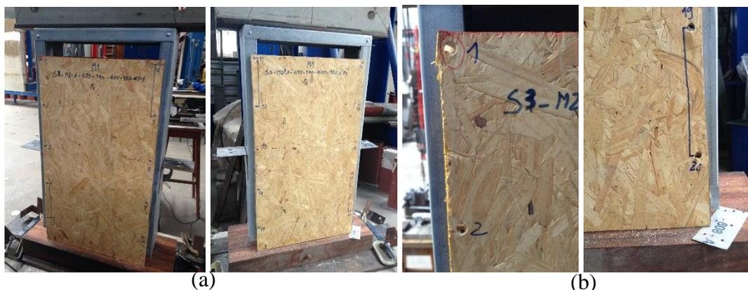
Figura 5.17 – Modelo M1 S3-M2-A-0,95-140-400-150 CP1: a) antes e b) depois do ensaio.
