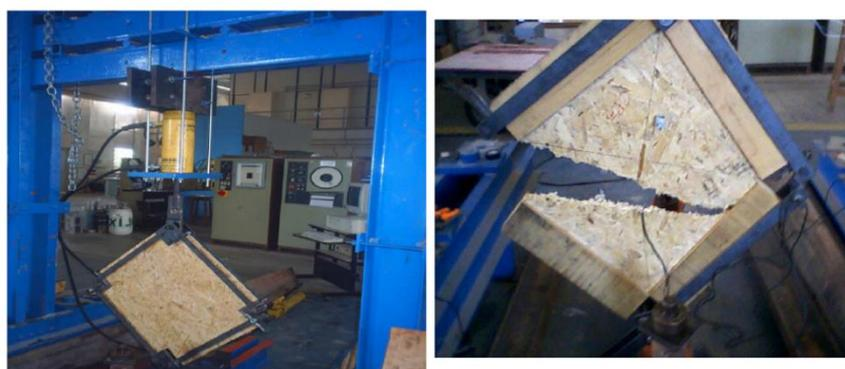
Figura 2.10 – Ensaio de cisalhamento por tração (Bastos, 2009).
