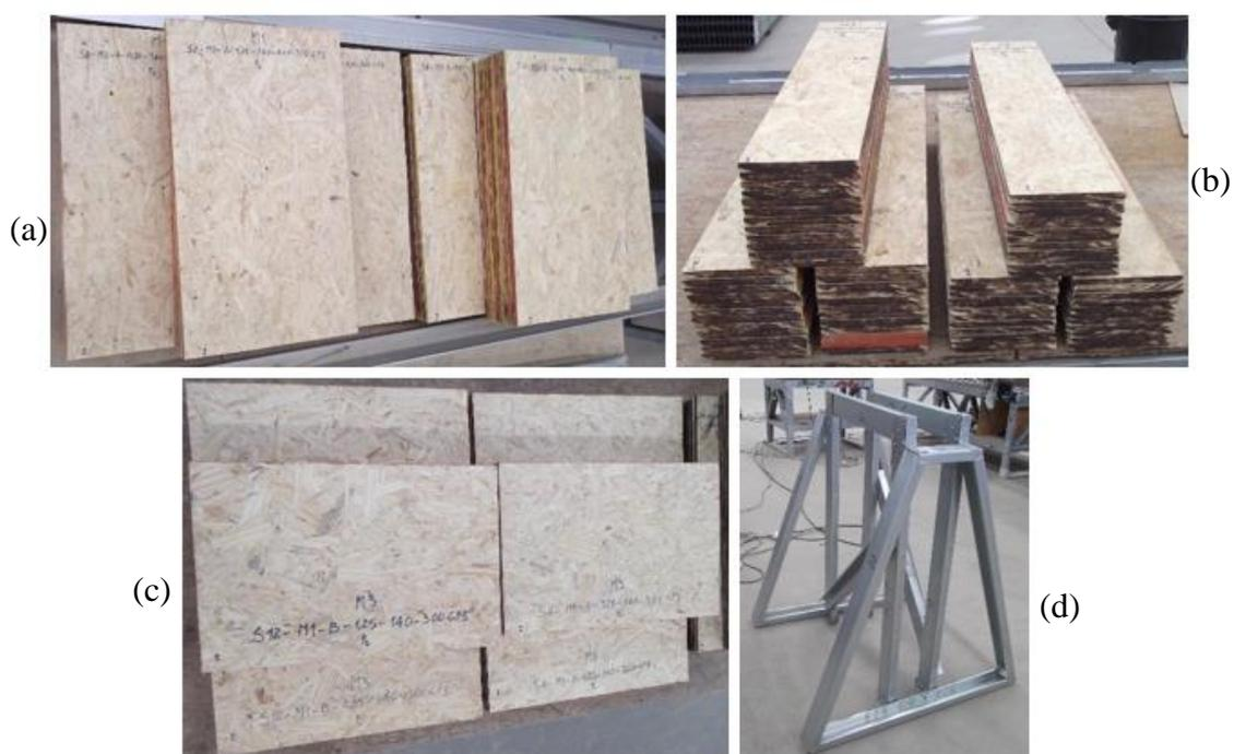
Figura 5.4 – Painéis de OSB cortadas e suporte fabricado para ensaio do modelo M3: a) modelo M1; b) modelo M2; c) modelo M3; d) suporte.
