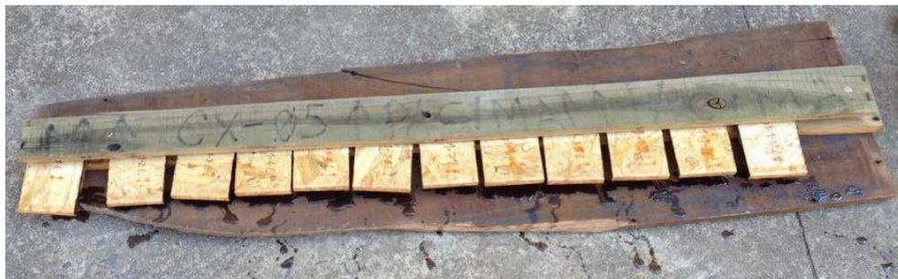
Figura 4.5 – Disposição dos corpos de prova para secagem do adesivo.
