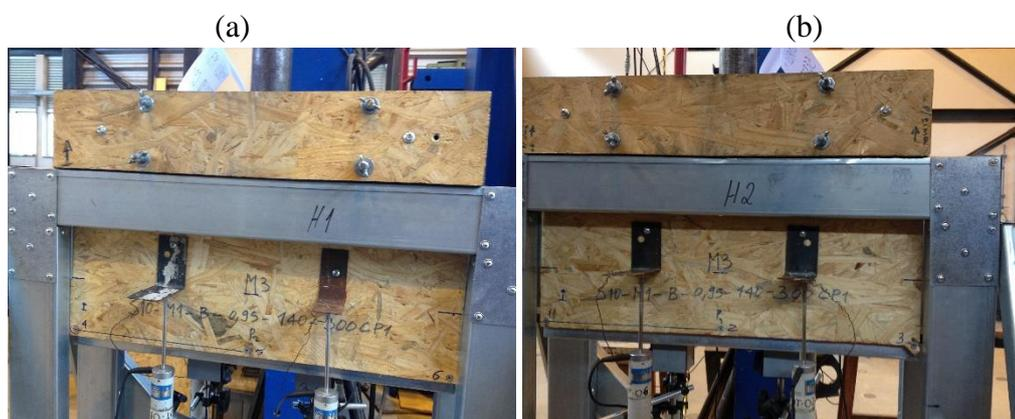
Figura 5.63 – Modelo M3 S10-M1-B-0,95-140-300 CP1: a) antes e b) depois do ensaio.
