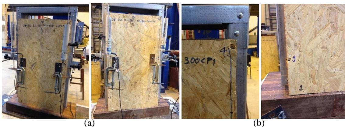
Figura 5.23 – Modelo M1 S8-M2-B-0,80-140-400-300 CP1: a) antes e b) depois do ensaio.
