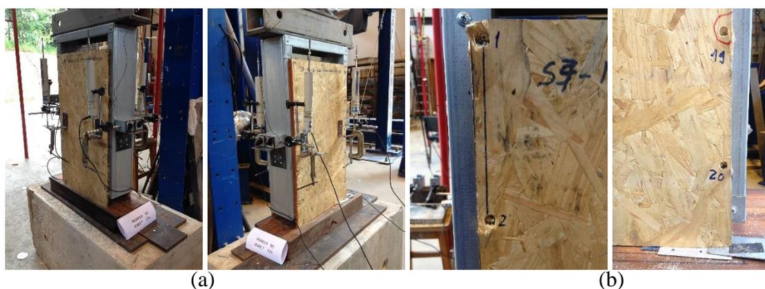
Figura 5.21 – Modelo M1 S7-M2-B-0,80-140-400-150 CP1: a) antes e b) depois do ensaio.
