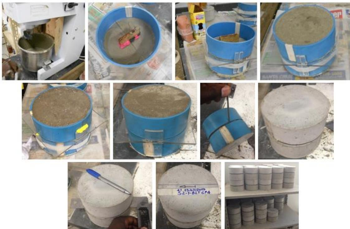
Figura 4.9 – Processo de fabricação dos corpos de prova.
