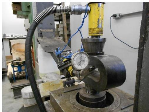
Figura 4.15 – Anel dinamométrico com cilindro hidráulico.
