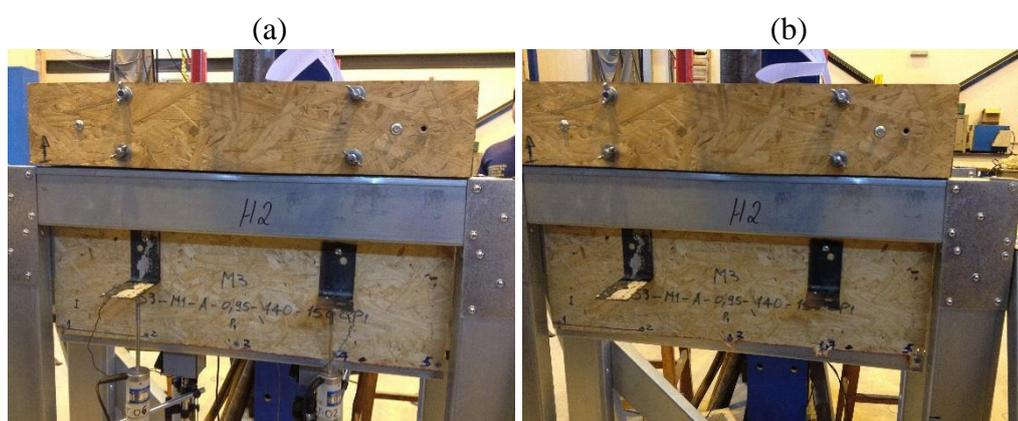
Figura 5.53 – Modelo M3 S3-M1-A-0,95-140-150 CP1: a) antes e b) depois do ensaio.
