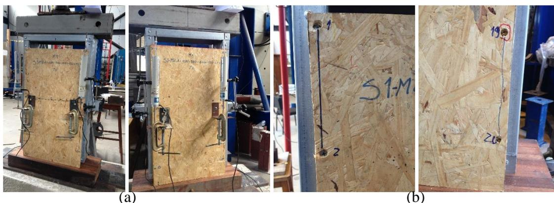
Figura 5.14 – Modelo M1 S1-M2-A-0,80-140-400-150 CP1: a) antes e b) depois do ensaio.
