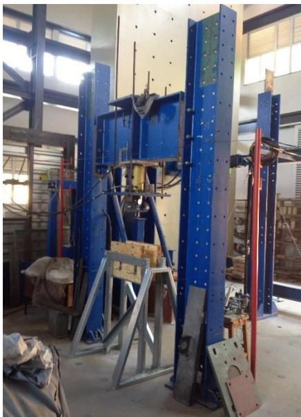
Figura 5.6 – Pórtico de reação, equipamentos e instrumentação durante ensaio de um dos CP's do modelo M3.
