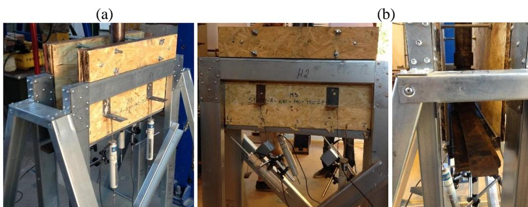
Figura 5.49 – Modelo M3 S1-M1-A-0,80-140-150 CP1: a) antes e b) depois do ensaio.
