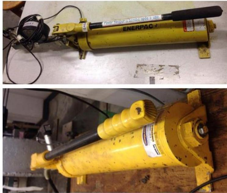
Figura 4.14 – Bombas Hidráulicas de ação manual de forças cisalhante e vertical.
