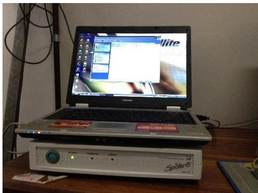
Figura 3.6 – Sistema de aquisição de dados e laptop com mouse.
