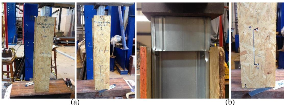
Figura 5.43 – Modelo M2 S9-M1-B-0,95-140-150 CP1: a) antes e b) depois do ensaio.
