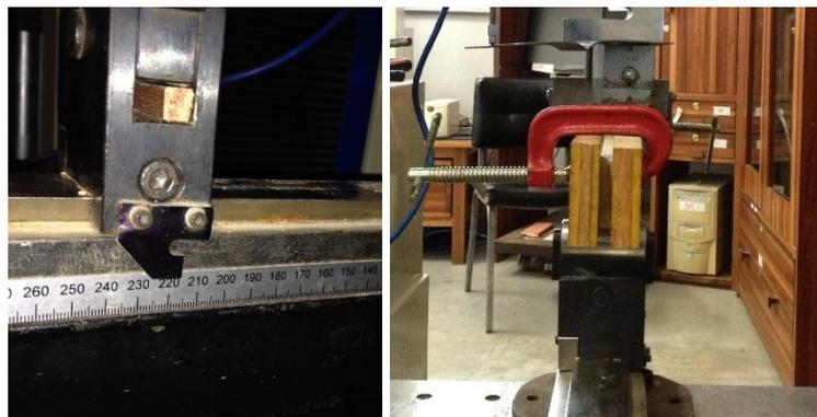
Figura 3.17 – Impedimento da rotação na base do apoio e estabilidade do CP para o ensaio.
