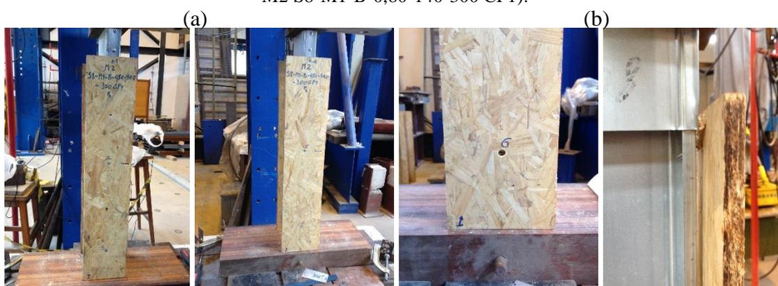
Figura 5.41 – Modelo M2 S8-M1-B-0,80-140-300 CP1: a) antes e b) depois do ensaio.
