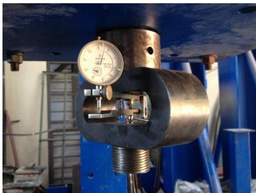
Figura 5.10 – Anel dinamométrico.
