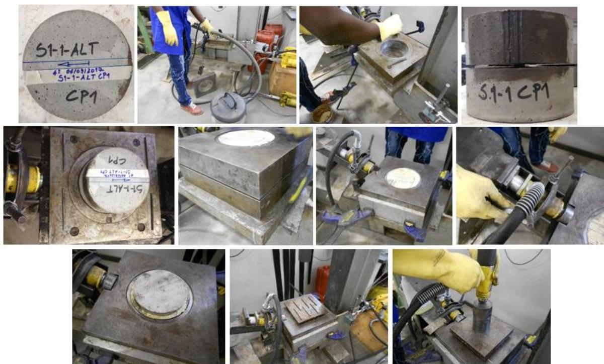
Figura 4.16 – Posicionamento do CP no quadro de cisalhamento.
