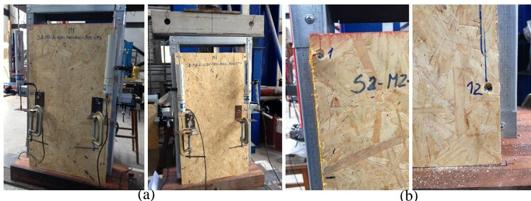
Figura 5.15 – Modelo M1 S2-M2-A-0,80-140-400-300 CP1: a) antes e b) depois do ensaio.
