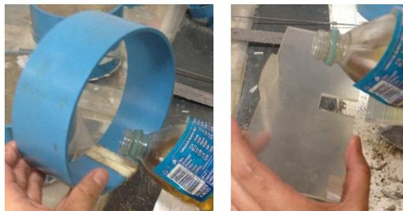
Figura 4.8 – Lubrificação do molde e da guia.
