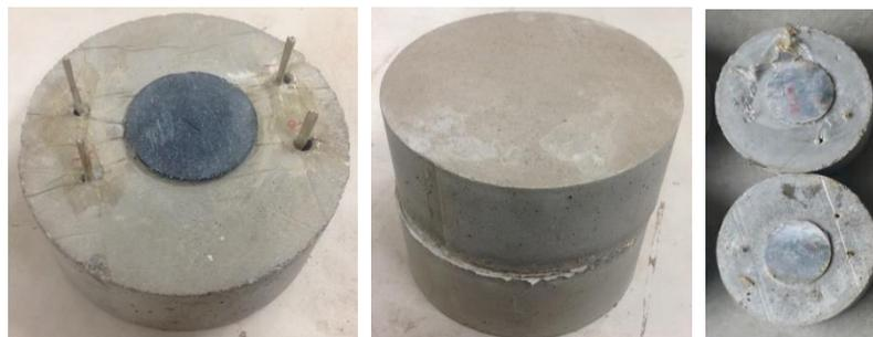
Figura 4.3 – Composição do CP com corpo de prova de rocha.
