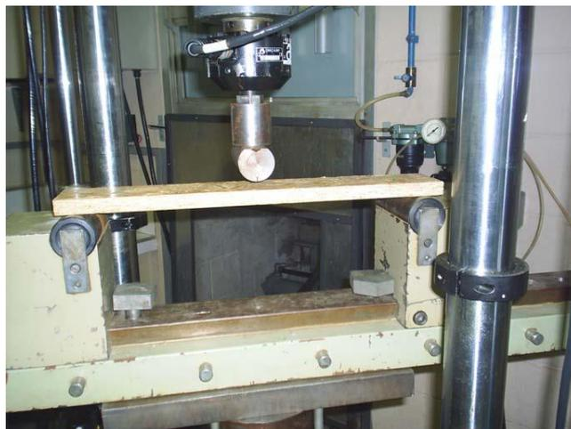
Figura 2.8 – Ensaio de flexão (Bastos, 2009).
