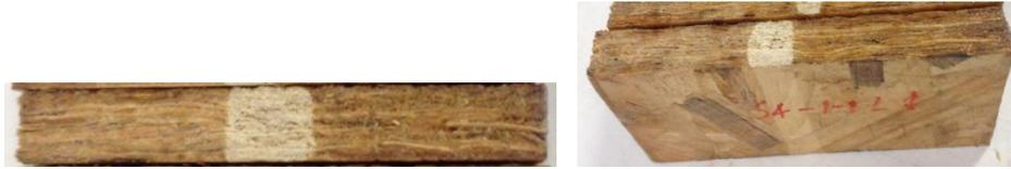
Figura 4.4 – Faixa de 5 mm ao longo da parte central do corpo de prova de OSB.
