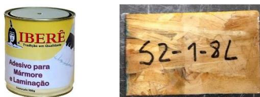
Figura 4.1 – Adesivo e sua aplicação no corpo de prova de OSB.
