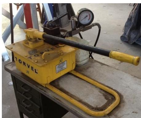
Figura 5.11 – Bomba hidráulica manual.
