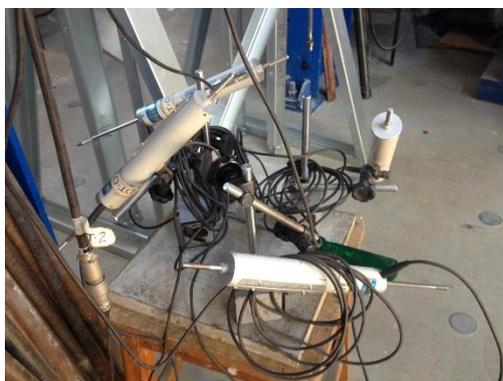
Figura 5.7 – DT's usados nos ensaios.
