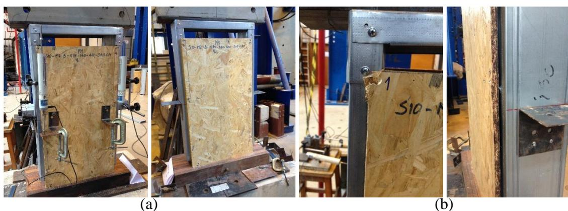
Figura 5.27 – Modelo M1 S10-M2-B-0,95-140-400-300 CP1: a) antes e b) depois do ensaio.
