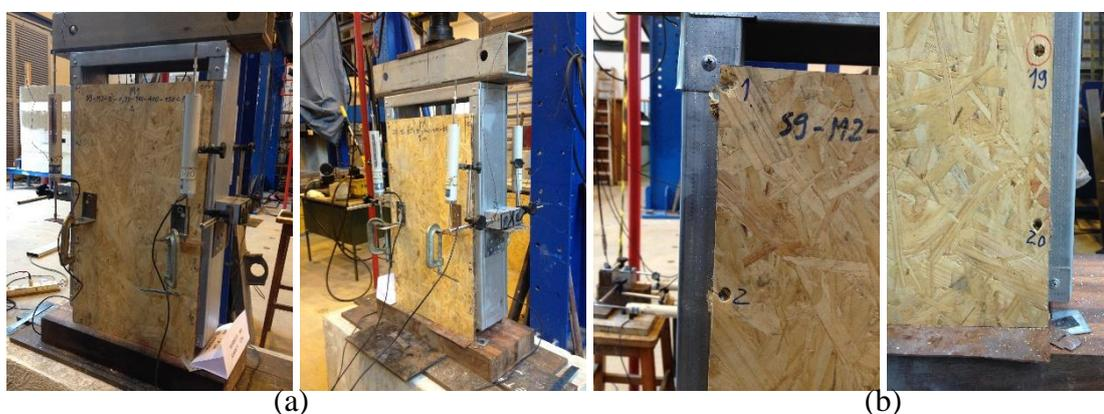
Figura 5.25 – Modelo M1 S9-M2-B-0,95-140-400-150 CP1: a) antes e b) depois do ensaio.
