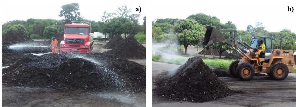
Figura 4.11 – Adição de água (a) e revolvimento das leiras (b). CTRS BR-040, Belo Horizonte, 2016.
