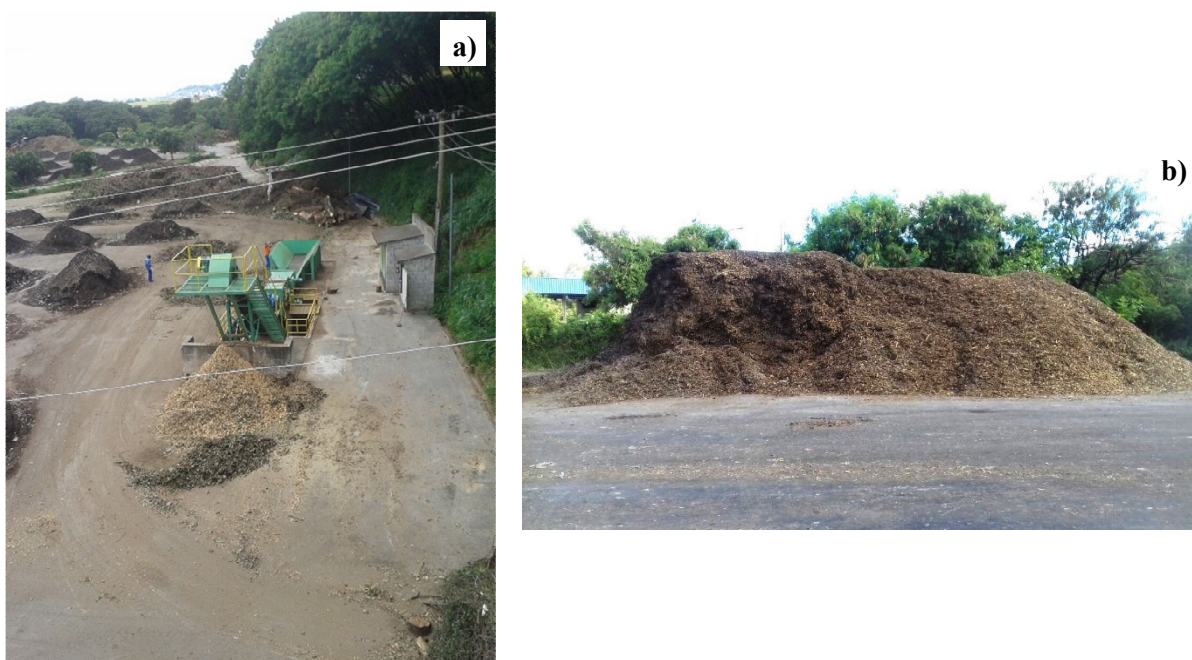
Figura 4.8 - Triturador de toras (a) e monte de armazenamento da poda de árvores triturada (b). CTRS BR-040, Belo Horizonte, 2016.
