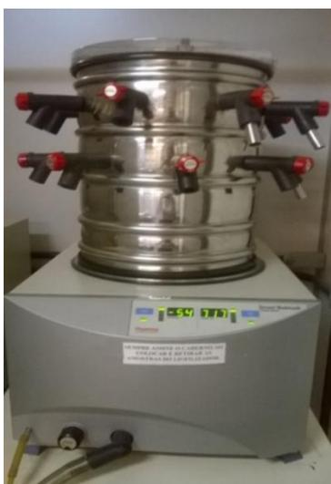
**Figura 38** - Liofilizador Savant Mdulyo D - Freeze Dryer(Thermo Electron Corp).
