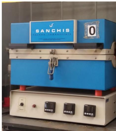
Figura 16 - Forno Tubular SANCHIS, potência de 1,8 KW.
