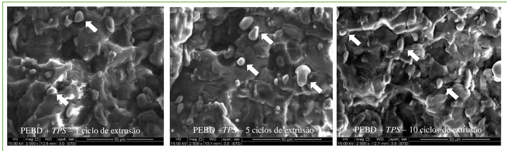
Figura 78: Micrografias obtidas por MEV das amostras de PEBD com 1, 5 e 10 ciclos de extrusão. As setas brancas apontam a distribuição do TPS.
