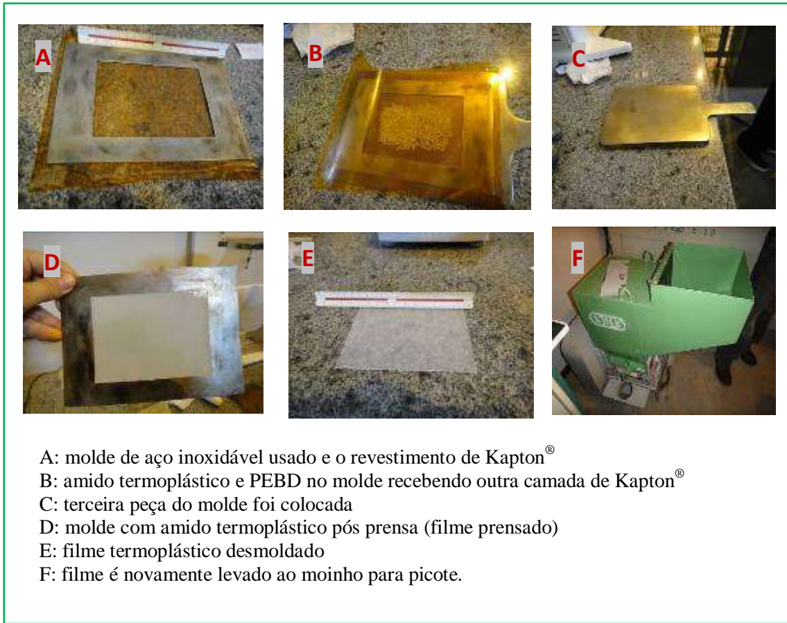
Figura 33: Preparo para a prensagem do amido termoplástico.
