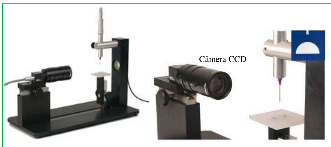
Figura 45: Medidor de ângulo de contato Digidrop modelo DGD inst DI. Fonte: Adaptado de PHADKE (2014)
