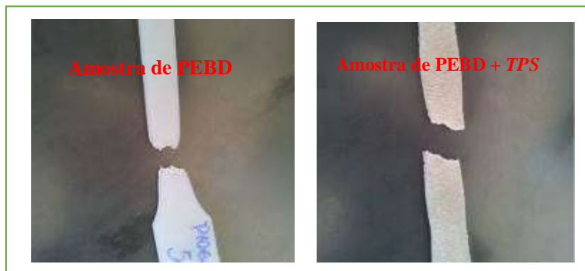
Figura 74: Detalhe da fratura da amostra de PEBD e da amostra de PEBD + TPS.
