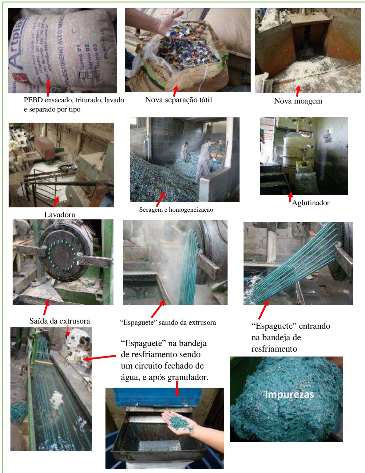
Figura 23: Ilustração do fluxograma do processo de reciclagem na “recicladora”.
