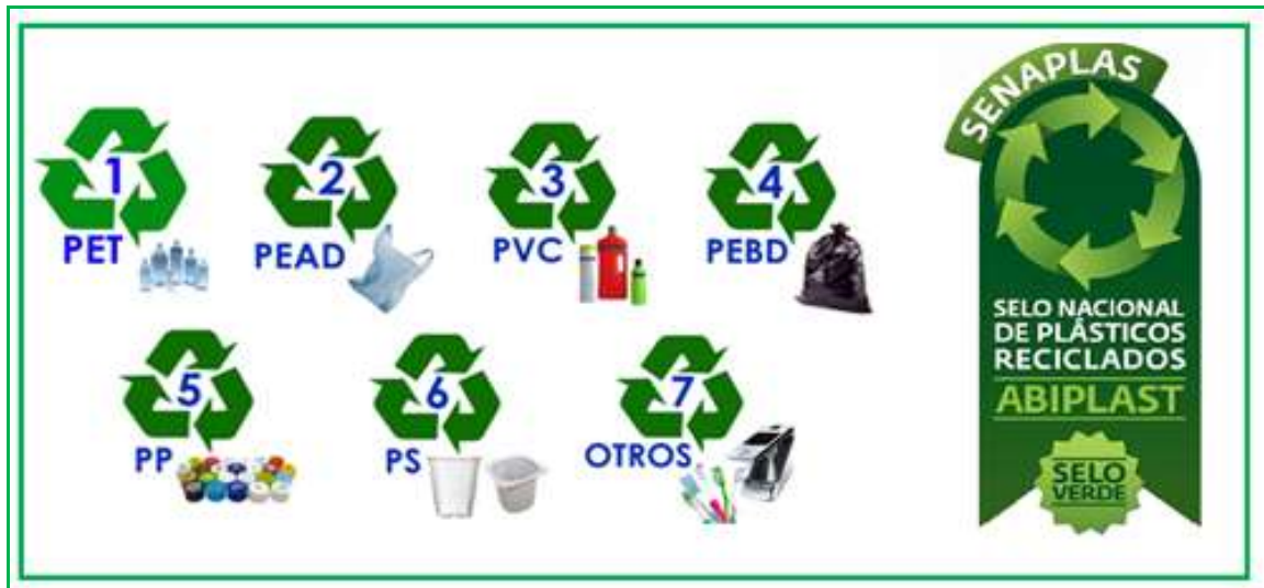
Figura 21: Símbolos para classificação de cada polímero e o selo SENAPLAS da ABIPLAST para qualidade de plásticos reciclados.
