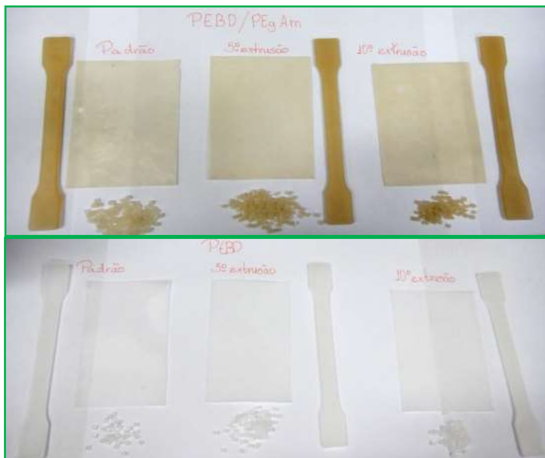
Figura 62: Amostras para ensaio de tração, amostras para caracterização e granulados após 1, 5 e 10 ciclos de extrusão de PEBD + TPS e PEBD.
