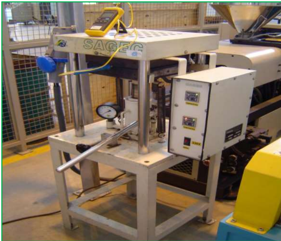
Figura 32: Prensa manual com placas aquecidas – marca SAGEC.
