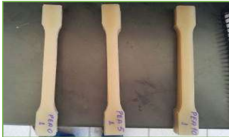
Figura 73: Corpos de prova com 1, 5 e 10 ciclos de extrusão da blenda PEBD + TPS.
