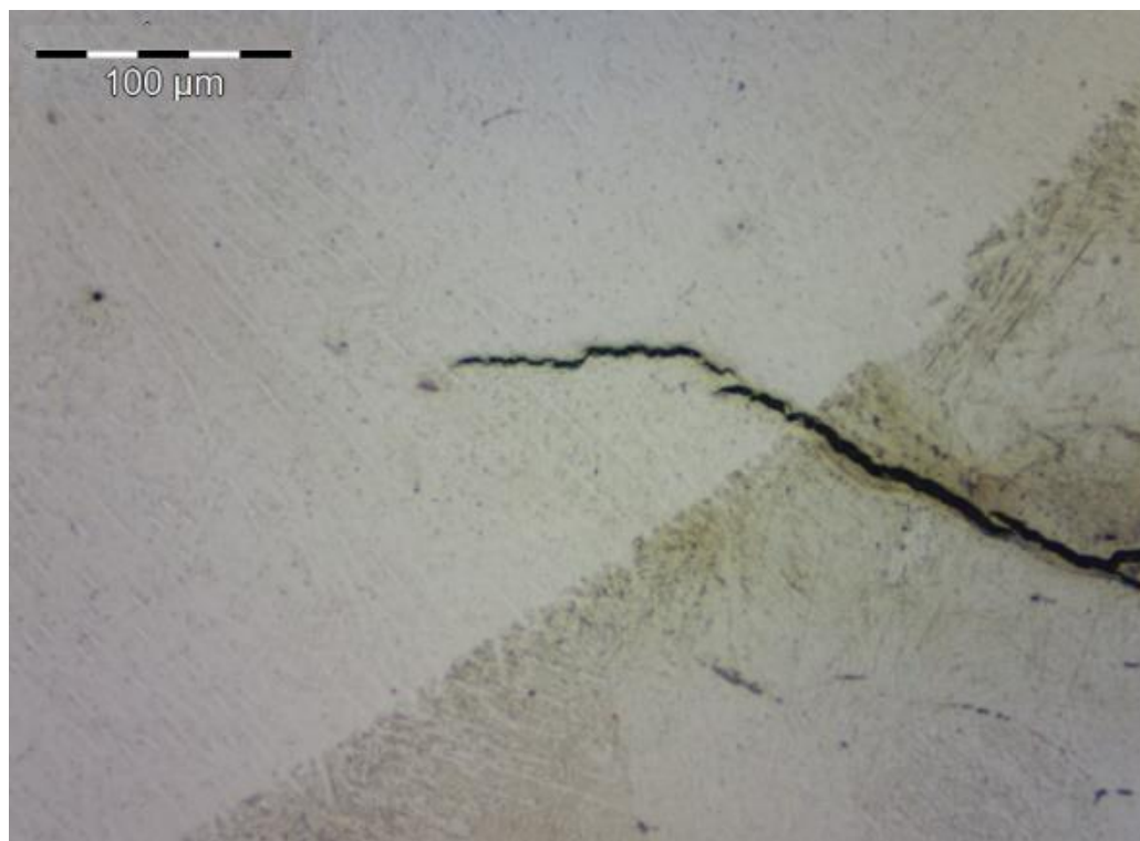
Figura 5. 19 – Trinca pelo hidrogênio na ZTA que parece ter crescido em direção a ZF.
