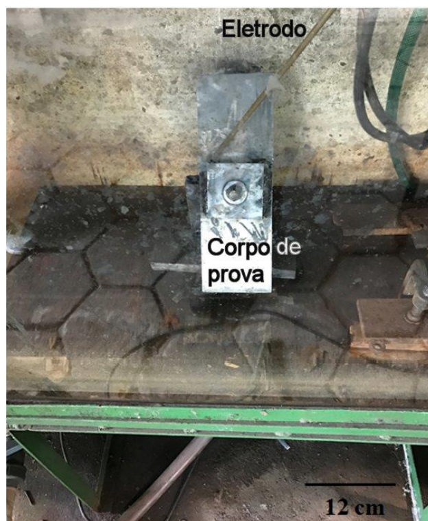
Figura 4. 12 – Corpo de Prova Posicionado no Tanque.
