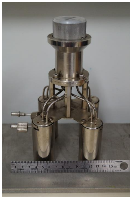
Figura 4. 4 – Porta amostras para teste de hidrogênio difusível.
