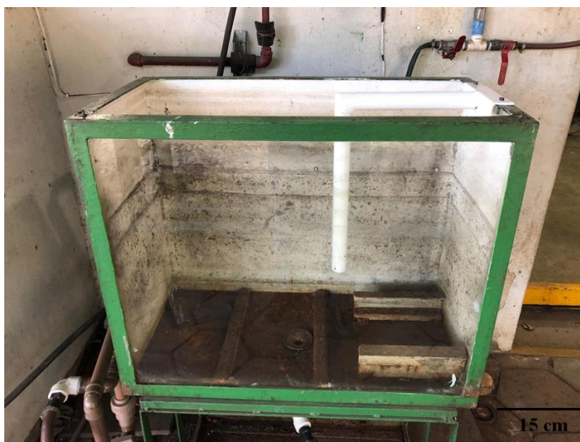
Figura 4. 6 - Tanque aberto de soldagem subaquático.
