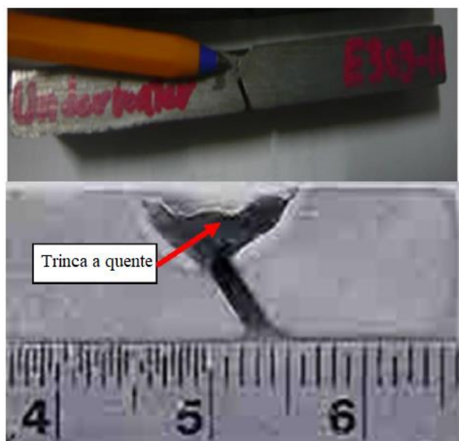
Figura 3. 11 - Trinca a quente no metal de solda, obtida com eletrodo E309-16 [27].
