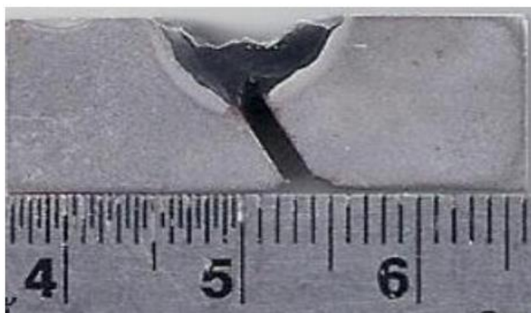
Figura 3. 12 - Teste TEKKEN usando o eletrodo E312-16 [27].
