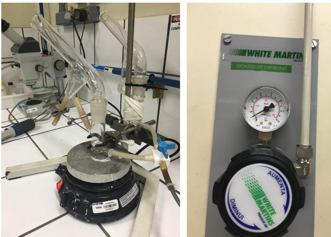
Figura 4.3 - Foto da montagem dos testes de microflotação, foram utilizados gás de linha, tanto de ar comprimido quanto de CO<sub>2</sub>
