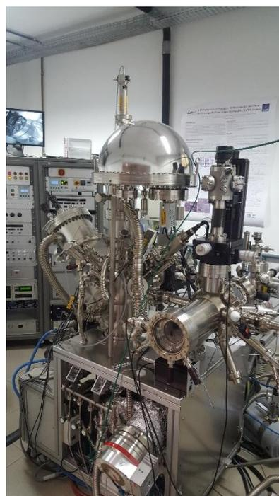
Figura 4.6 - À esquerda diagrama esquemático de um analisador de XPS (Fonte: MOULDER, 1992); à direita equipamento de XPS do laboratório de Laboratório de Superfícies e Nanoestruturas –LabSurf do CBPF (Centro Brasileiro de Pesquisas Físicas - RJ)
