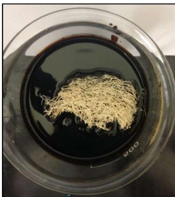
Figura 29: Vista de cima da inserção da bucha vegetal no sistema petróleo-água.
