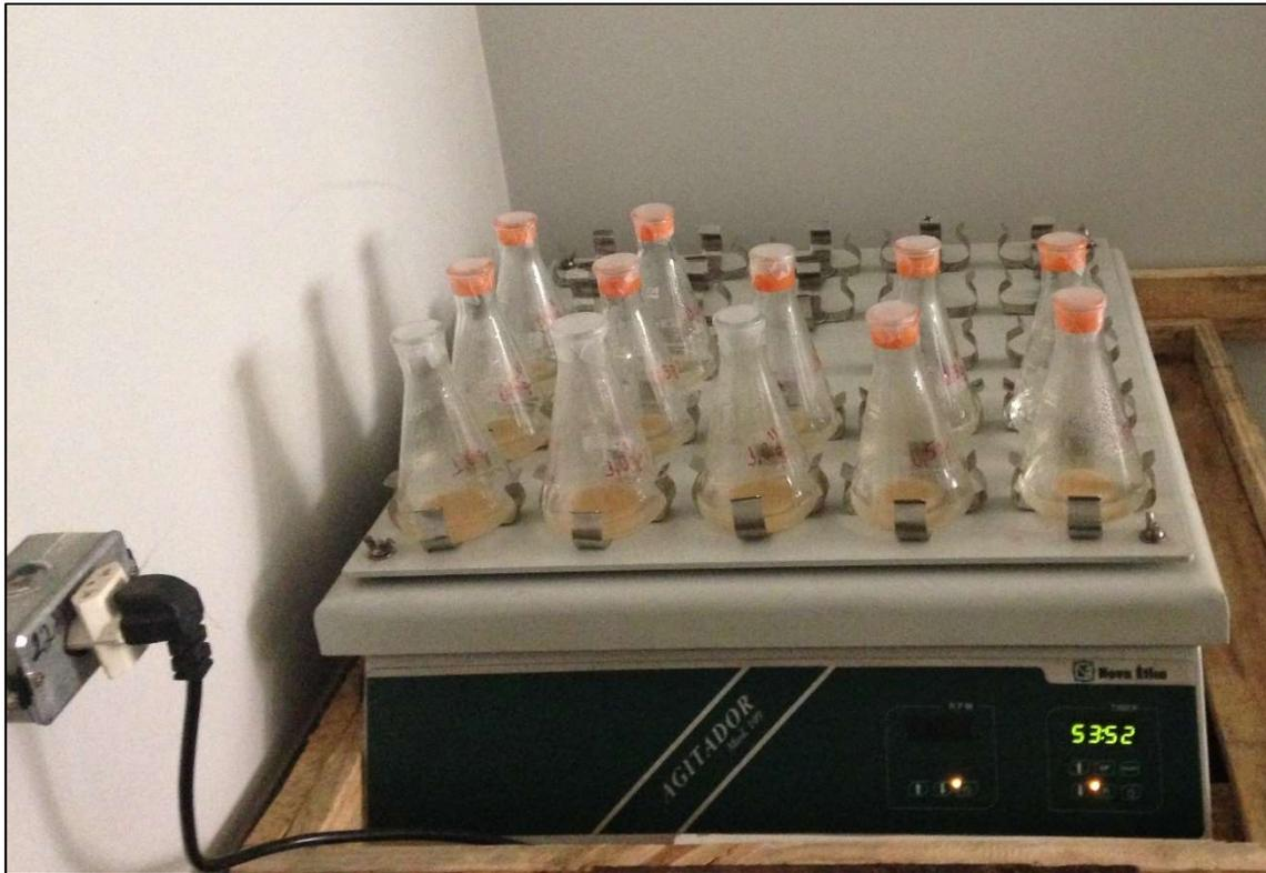
Figura 40- Montagem – Mesa agitadora de frascos para ensaios de adsorção
