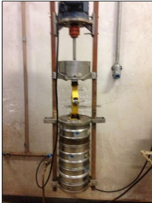
Figura 26- Sistema de peneiramento
