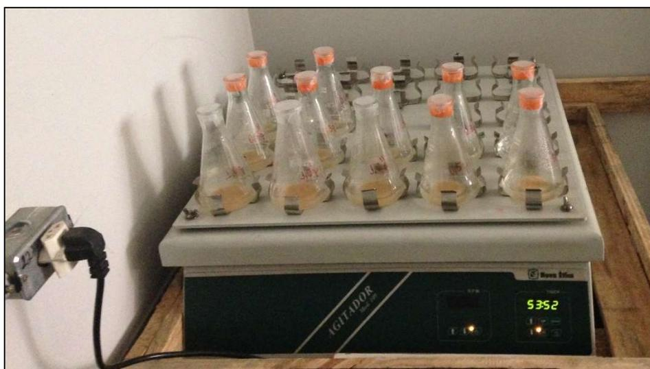
Figura 41- Montagem utilizada para os ensaios cinéticos de adsorção de eteramina por *Luffa Cylindrica* modificada
