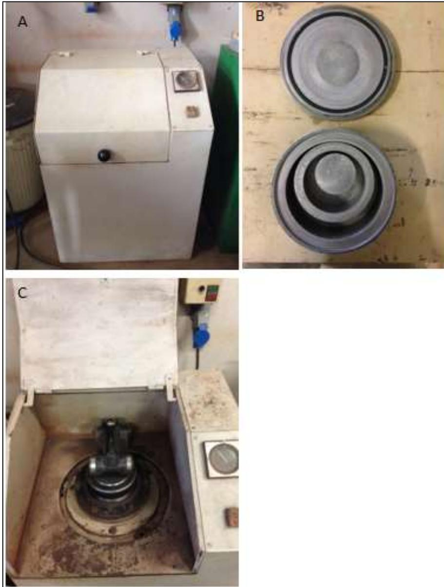
Figura 25- Moinho de panela: A) moinho fechado, B) Partes constituintes da panela, C) Panela inserida no moinho
