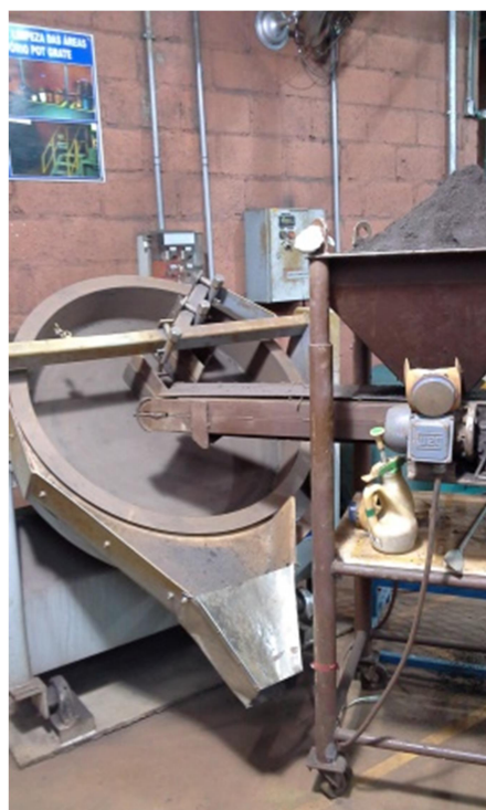
Figura 4.7 - Disco piloto de pelotamento.
