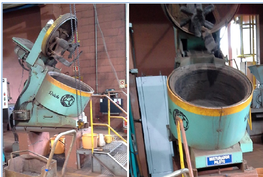
Figura 4.6 - Misturador Eirich modelo R-08W.
