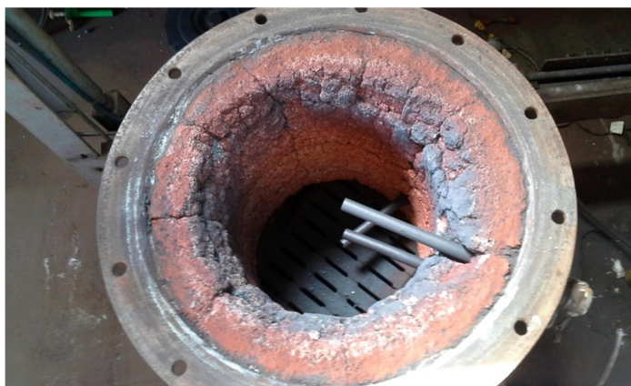
Figura 4.9 - Panela vazia e tubos internos para posicionamento dos termopares de controle.
