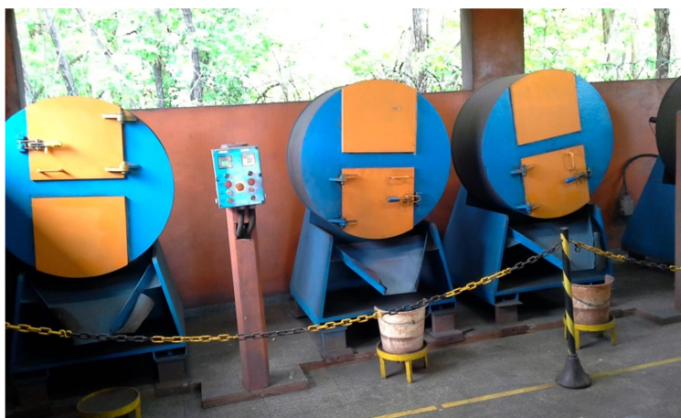
Figura 4.12 - Tambores rotativos utilizados para realização do ensaio de tamboramento.
