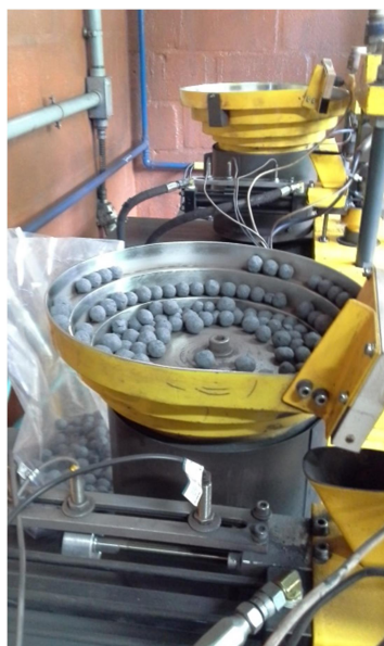
Figura 4.13 - Prato de distribuição e alimentação da prensa.
