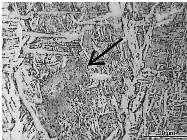
Figura 5. 9 – Ilha de martensita (indicada pela seta) na ZF da amostra na condição E8010, com ataque de Nital 2%. Ampliação original de 1000x.
