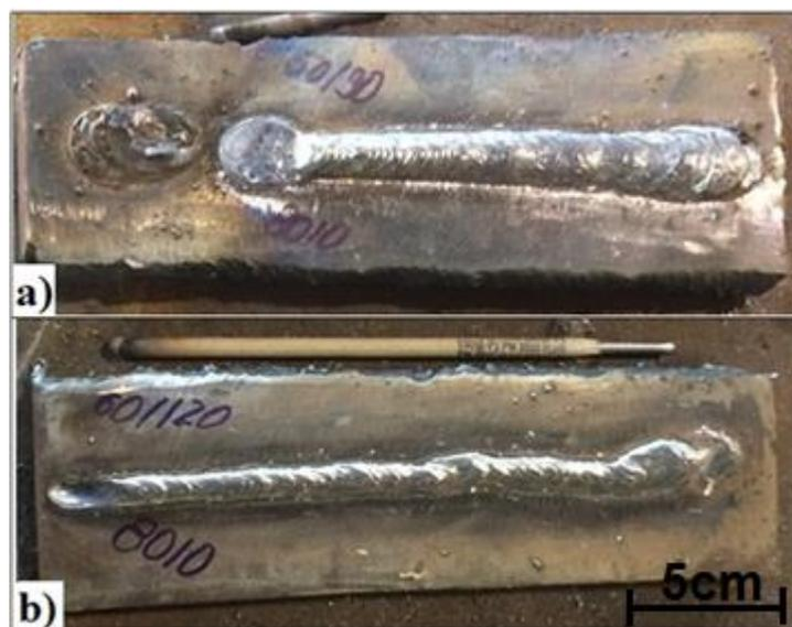
Figura 5. 4 - Cordões de solda utilizando o eletrodo E8010 Plus: a) ângulo da haste em  $0^\circ$  b) ângulo da haste em  $-30^\circ$ .
