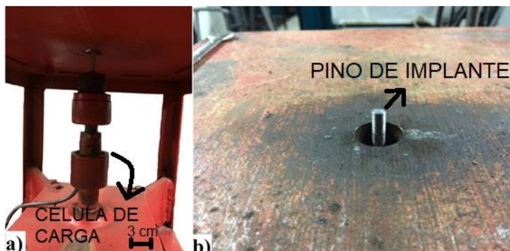
Figura 4. 11 – a) Vista lateral do pino de implante posicionado junto à célula de carga; b) Vista superior do pino de implante posicionado.
