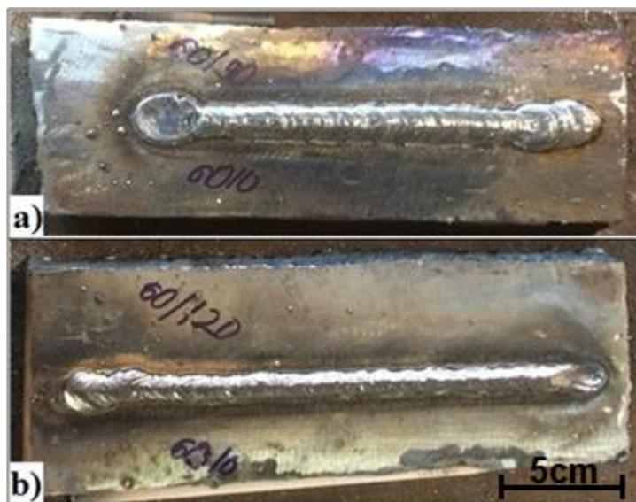
Figura 5. 3 – Cordões de solda utilizando o eletrodo E6010 Plus: a) ângulo da haste em  $0^\circ$  b) ângulo da haste em  $-30^\circ$ .
