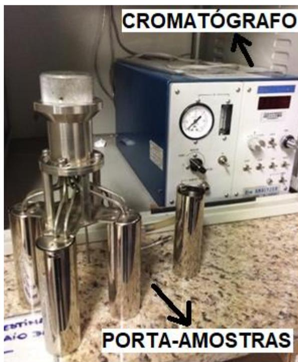
Figura 4. 1 – Cromatógrafo e *sample* utilizados no ensaio.
