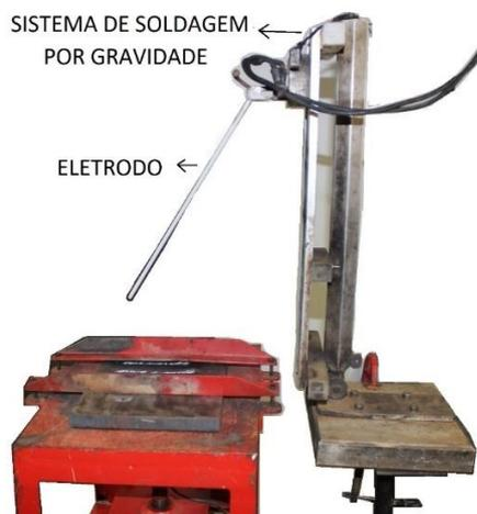
Figura 4. 3 – Sistema de soldagem por gravidade.
