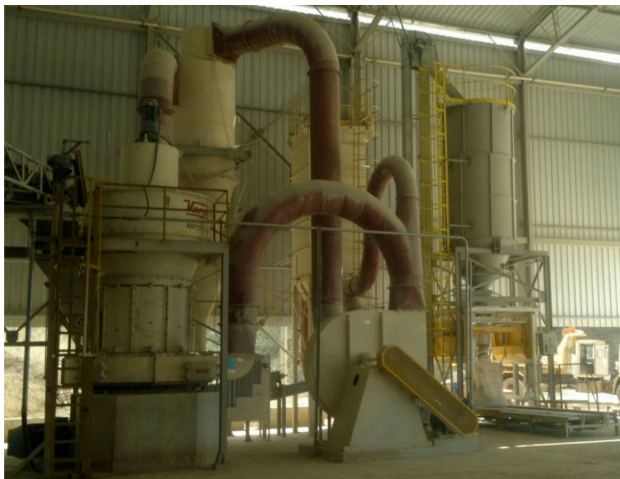
FIGURA 4-4: Moinho pendular tipo Raymond, modelo MP275, fabricante Verdés, utilizado no processo de moagem dos materiais.
