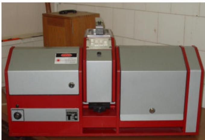
FIGURA 4-8: Equipamento Sympatec Helos 12LA Vectra, utilizado para análise granulométrica dos materiais ultrafinos.
