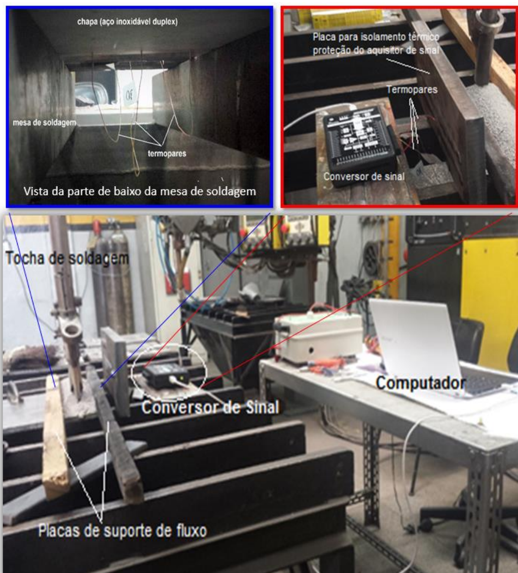
Figura 4.4. Montagem do sistema de aquisição de dados dos ciclos térmicos das soldagens
