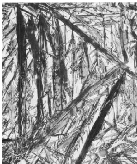
Figura 3.23: Microestrutura martensítica em uma liga Fe-1,8C. Aumento de 500X e reagente nital 2%. Adaptação de KRAUSS (2005).
