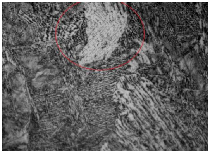
Figura 3.20: Microestrutura da zona fundida de um aço SAE4130 soldado por TIG, mostrando o de uma região com agregados ferrita-carboneto. Ampliação de 1000x e ataque Nital 2%. Adaptação de BUENO (2010).
