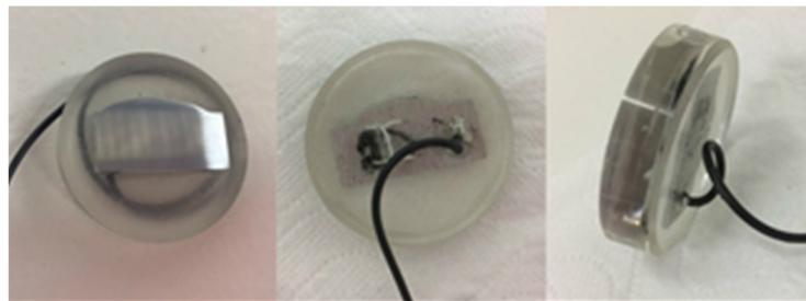
Figura 4.11: Exemplo de amostras de secção transversal com fio de cobre soldado embutidas em resina epóxi para ensaio de CPP.
