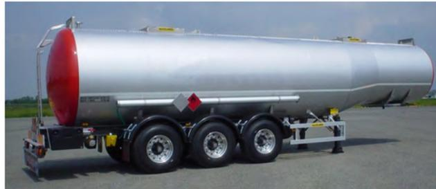
Figura 3.11: Um tanque móvel para transporte rodoviário em LDX 2101®.
