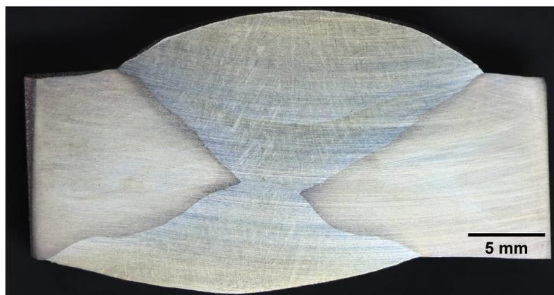
Figura 5.45: Macrografia da junta soldada. Ataque: Behara II.
