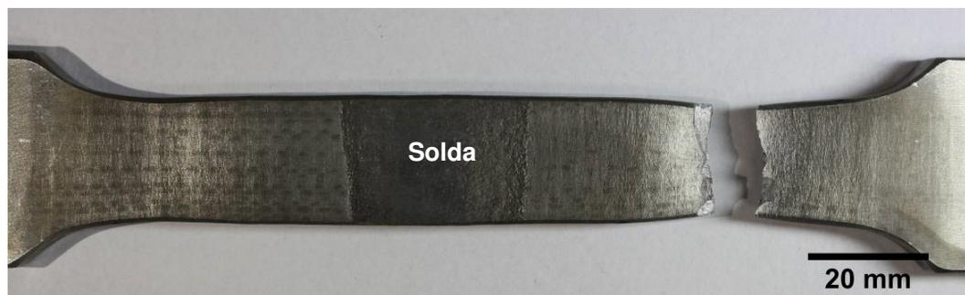
Figura 5.46: Corpo de prova de tração retangular após ensaio.
