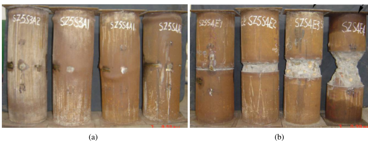
Figura 3.11: Amostras do estudo experimental de Yu et al. (2007) com furos (a) e entalhes (b) no perfil de aço.
