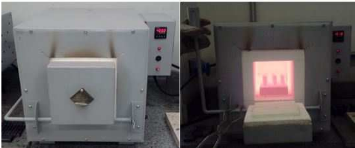
FIGURA 4.4 - Fornos utilizados para realizar o tratamento térmico no aço AISI D2.
