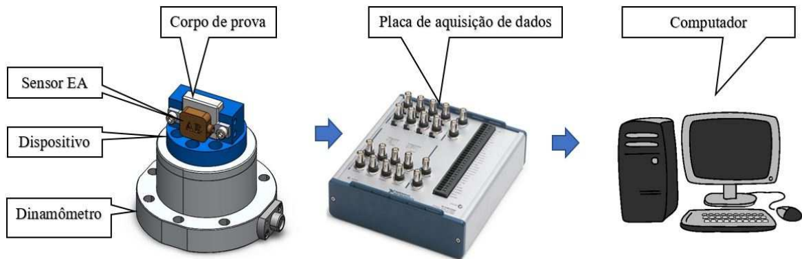
FIGURA 4.17 - Aquisição de dados dos sinais de força e emissão acústica.
