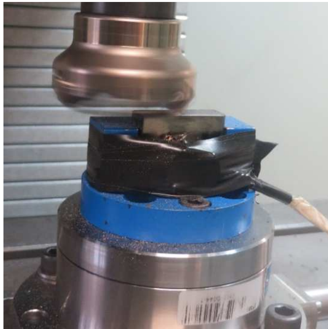
FIGURA 4.9 - Faceamento da superfície do corpo de prova para o ensaio de microfresamento.
