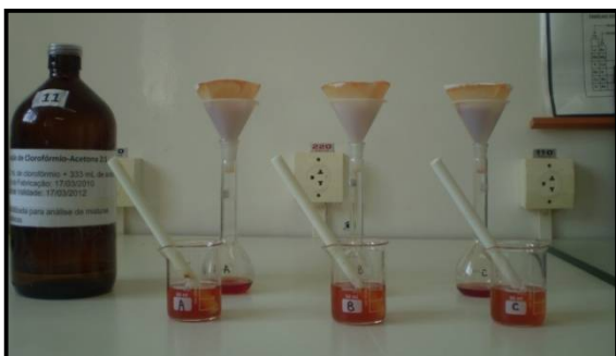
FIGURA 5.3 - EXTRATO OBTIDO EM MISTURA CLOROFÓRMIO-ACETONA (2:1).
