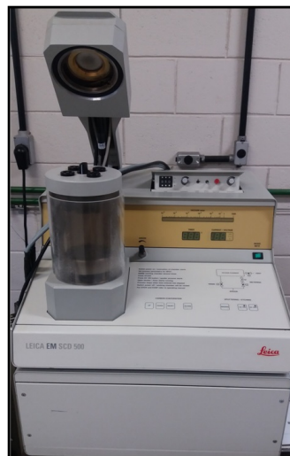
Figura 21 – Metalizadora LEICA EM SCD 500 usada para realizar a preparação das amostras.
