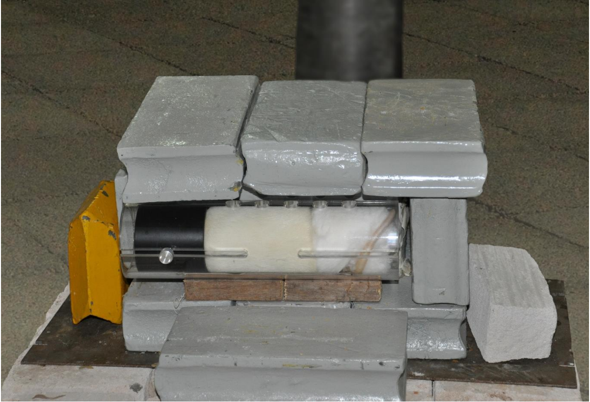
Figura 4- Rato anestesiado posicionado em dispositivo de acrílico protegido por placas de chumbo. A porção posterior do animal não apresentava proteção de chumbo para dispersar a radiação e evitar o efeito de reflexo, o que poderia gerar danos às estruturas adjacentes.
