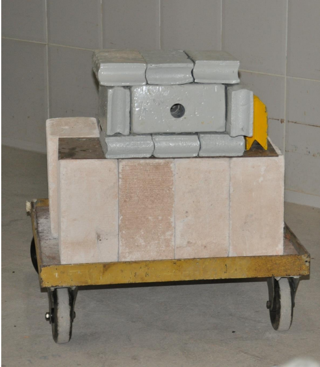
Figura 3- Proteção de chumbo com abertura central que funciona como colimador dos raios gama.
