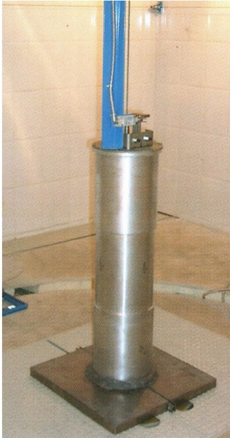
Figura 2- Fonte de Cobalto-60 localizada no centro da sala. A fonte encontra-se no subterrâneo e após o fechamento das portas e ativação do sistema, a fonte é içada por esta estrutura e irradia toda a sala.
