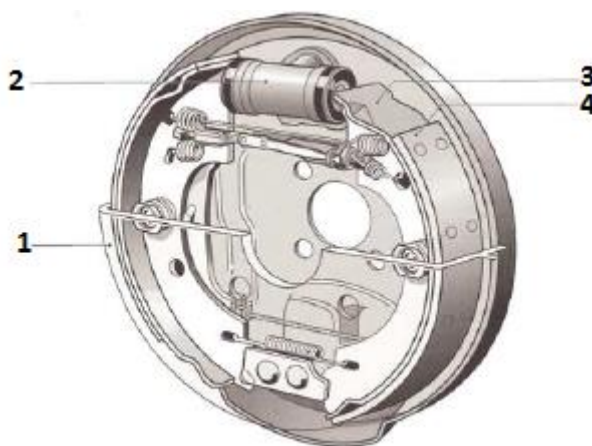
Figura 9 - Freio a tambor: 1) tambor de freio, 2) cilindro de freio, 3) sapata, 4) lona de freio. (VIVEROS, 2010)
