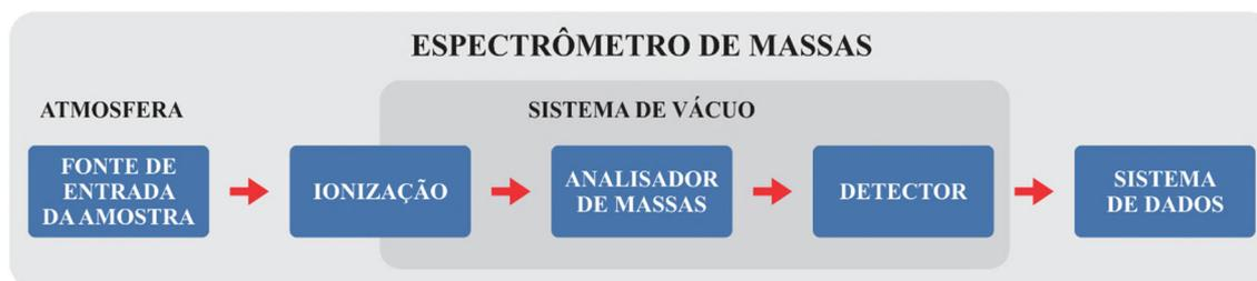
**Figura 5** - Esquema da sequência dos processos em uma análise por *Espectrometria de Massas*. A fonte de inserção da amostra pode ser acoplada à fonte de ionização.
