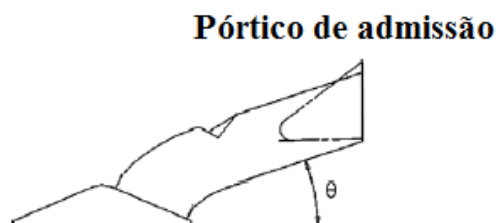
Figura 2.37 – Formato do pórtrico de admissão para \theta = 15^\circ, 20^\circ e 25^\circ
