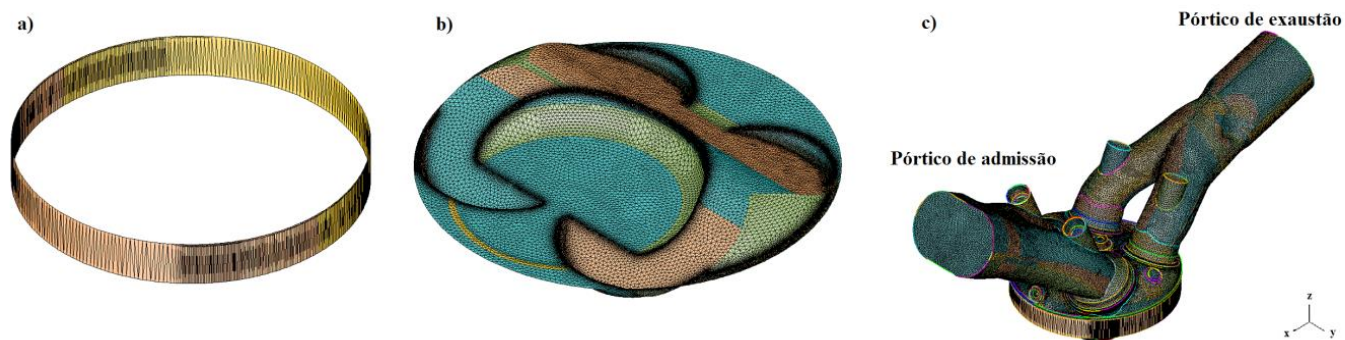
Figura 3.14 – Separação das regiões: a) Cilindro, b) pistão e c) cabeçote e pórticos das válvulas de admissão e exaustão com os respectivos perfis
