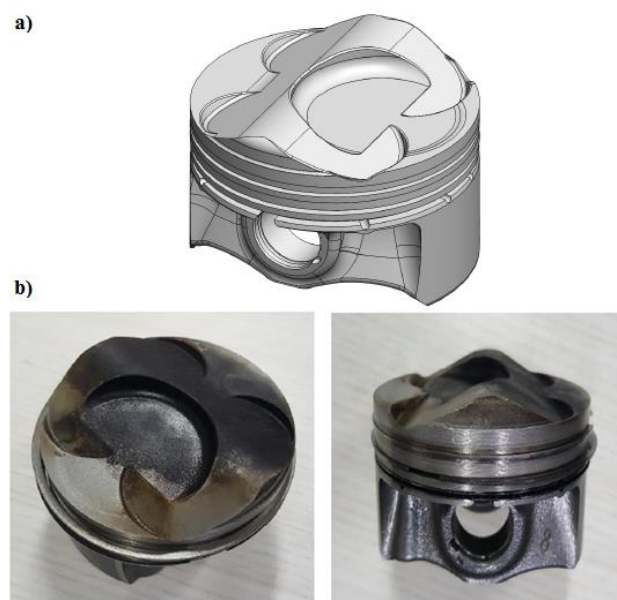
Figura 3.7 – a) CAD do pistão projetado pelo CTM-UFGM b) Pistão
