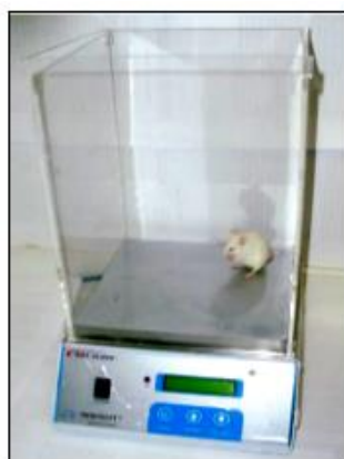
Figura 14: Aparato utilizado para a avaliação da resposta nociceptiva induzida por calor.
