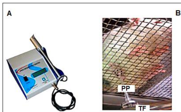
Figura 3: Analgesímetro digital utilizado para avaliação da alodínia mecânica (A); aparato e forma da avaliação da alodínia (B). PP - ponteira de polietileno; TF - transdutor de força. O sítio de estimulação é o centro delimitado pelos pontos pretos na pata.
