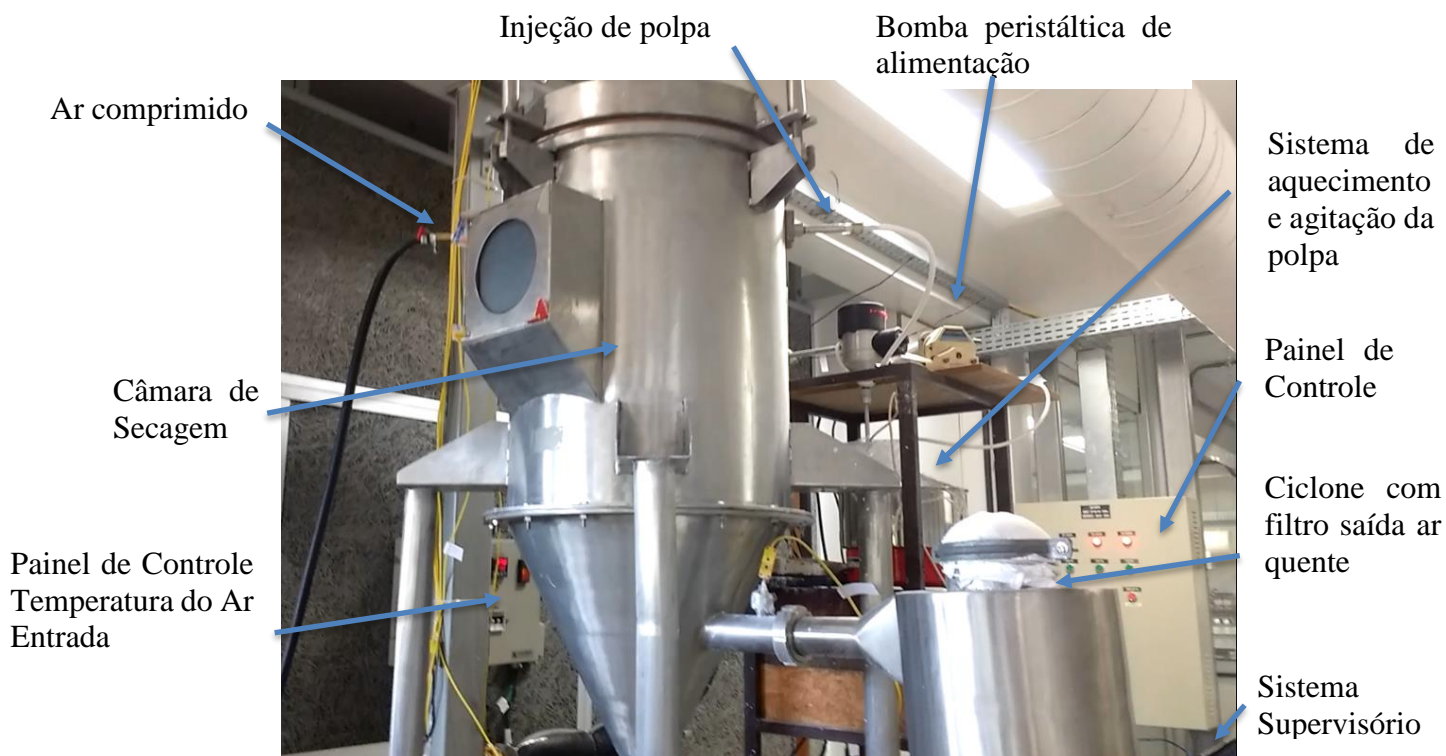
Figura 15 – Spray Dryer planta piloto LPI - DEQ/UFMG. Fonte: Próprio Autor,2017.
