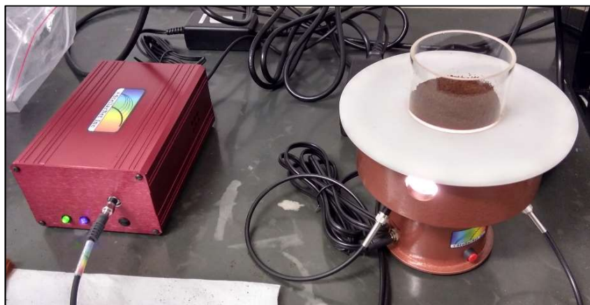
Figura 7 – Obtenção de espectro NIR para café no equipamento Red-Wave-NIRX-SR StellarNet®.
